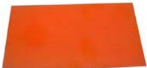
شکل ۴-۸- کلیشه خام فتوپلیمر
