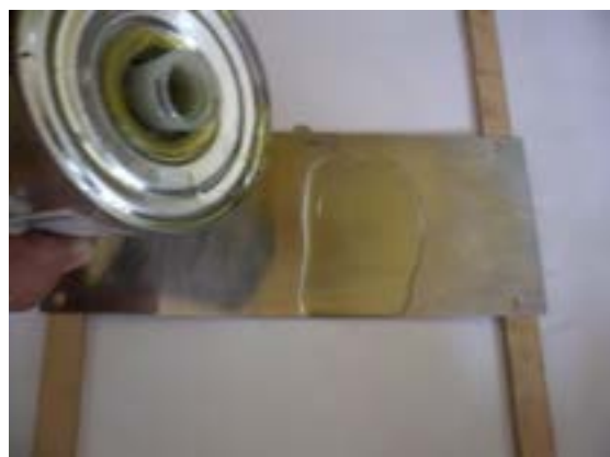
شکل ۱۴-۴- حساس کردن کلیشه خام
