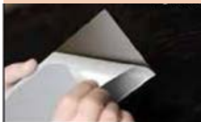
شکل ۱۵-۴- جدا کردن روکش محافظ
