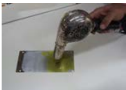
شکل ۴-۲۲- حرارت دادن کلیشه
