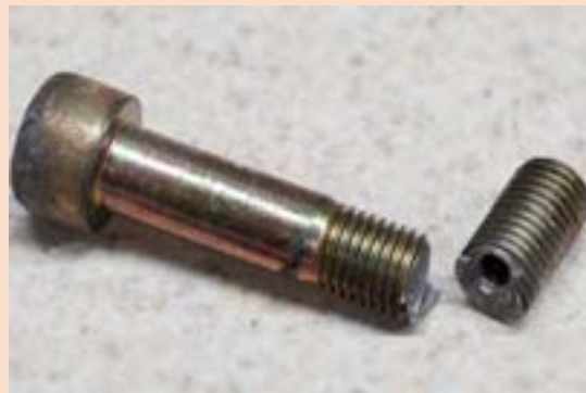
شکل ۳۰-۵ یک پیچ بریده شده بر اثر بارگذاری پیچشی شکل ۳۱-۵ میل‌گاردان بارگذاری پیچشی را برای انتقال گشتاور تحمل می‌نماید
