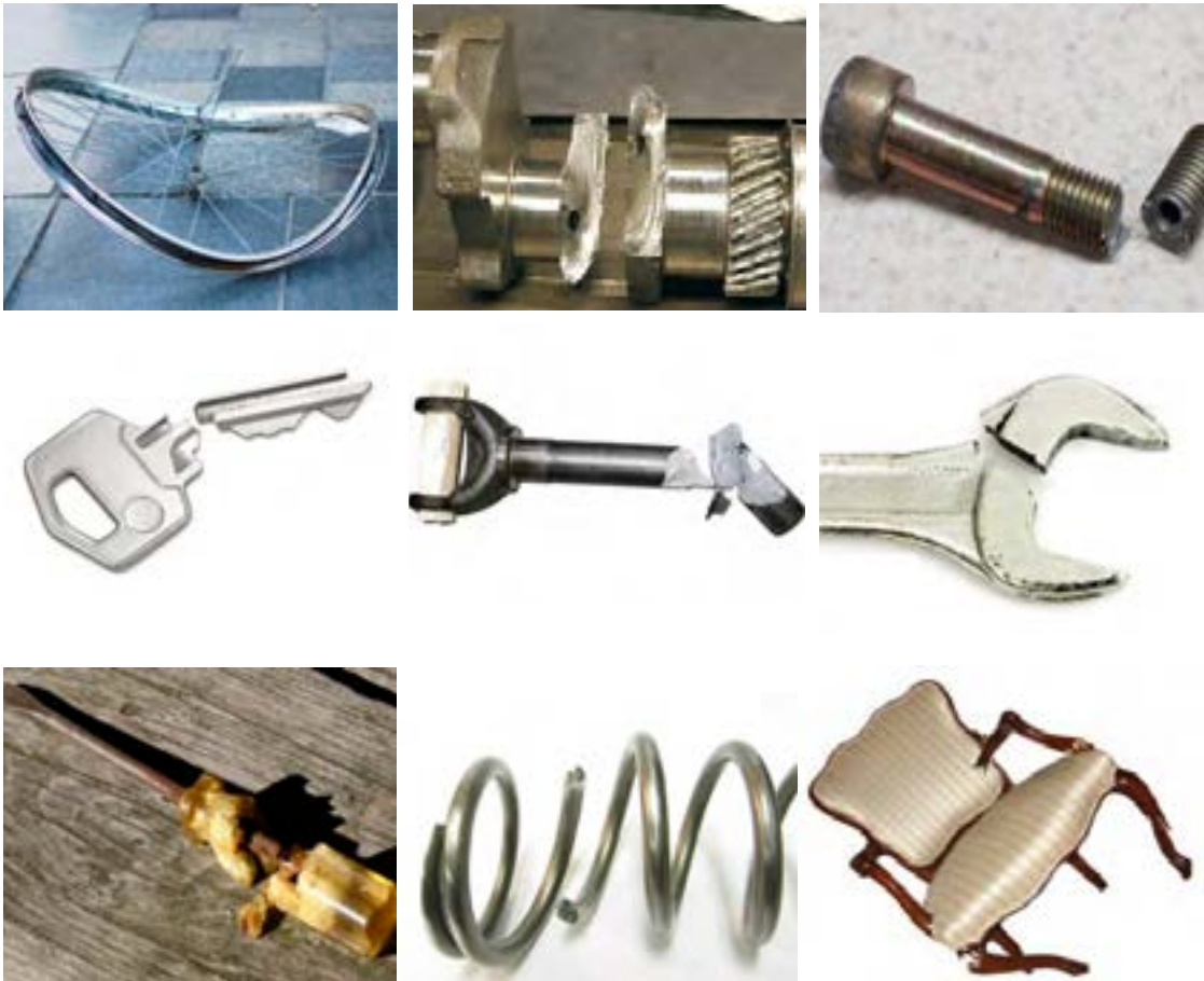
شکل ۱-۵- خرابی و شکست قطعات
