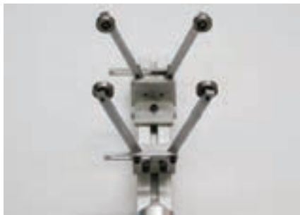
شکل ۵-۱۵ سیستم حرکتی قالب
