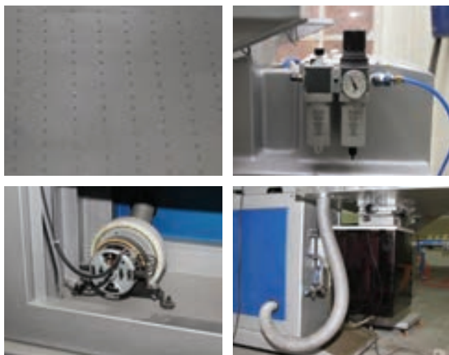
شکل ۵-۱۶ سیستم وکیوم دستگاه چاپ اسکرین
