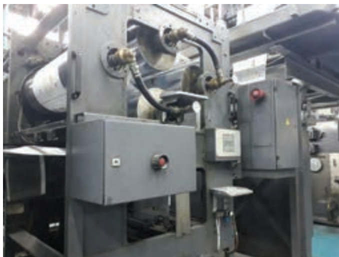
شکل ۲۸- بخش خنک کننده دستگاه افست رول هیت ست (Heat Set)
