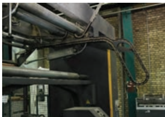
شکل ۲۶- سیستم کاغذ کشی زنجیری
