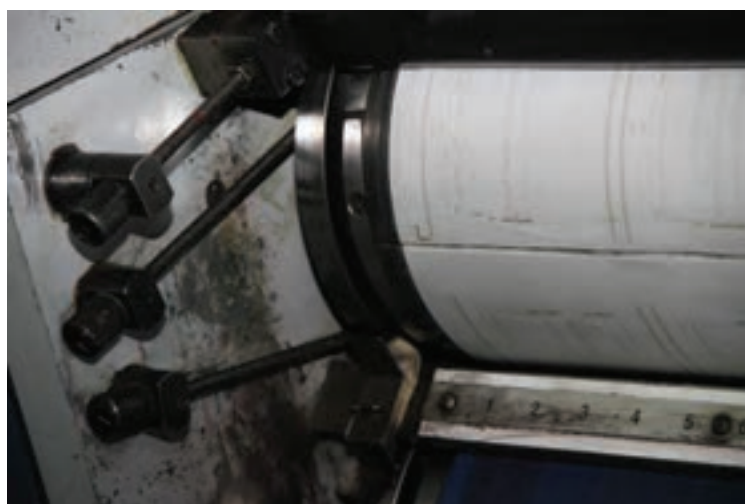
شکل ۵۳- شیار سیلندر (لبه‌های پلیت)
