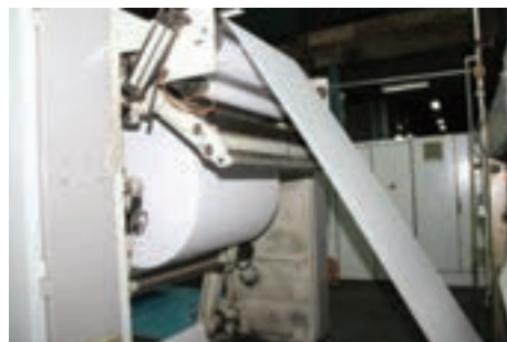
شکل ۹- سیستم عملکرد تغذیه بدون توقف (Splicer)
