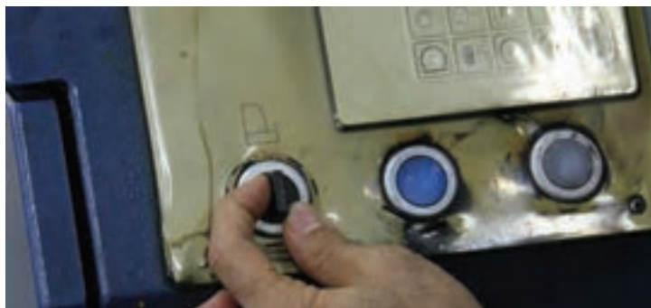
شکل ۵۲- کلید آزاد کردن سیلندرها
