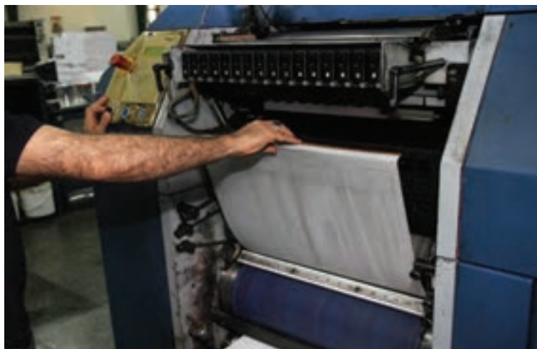
شکل ۵۶- نگاه‌داشتن پلیت برای بازکردن از روی سیلندر
