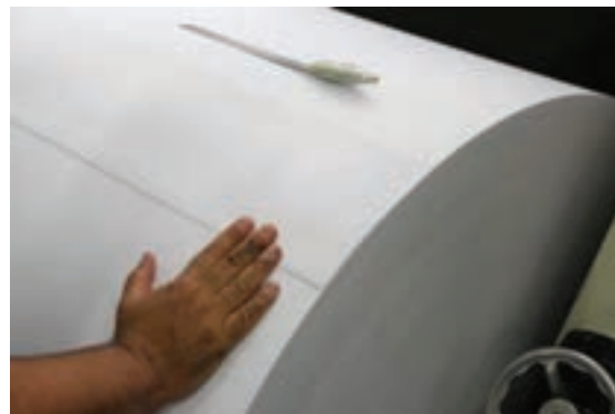
شکل ۱۶- تا کردن لبه رول
