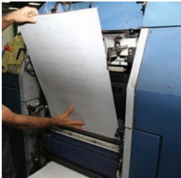
شکل ۶۹- قرار دادن لب کار در شیار سیلندر
