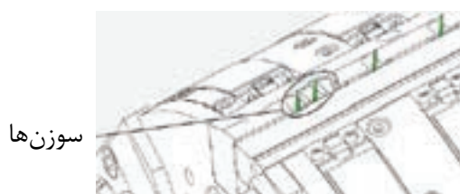
شکل ۳۸- سوزن های روی سیلندر
