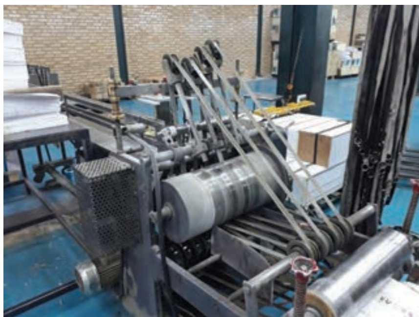
شکل ۴۸- سیلندر پرس و دسته کن (Stacker)
