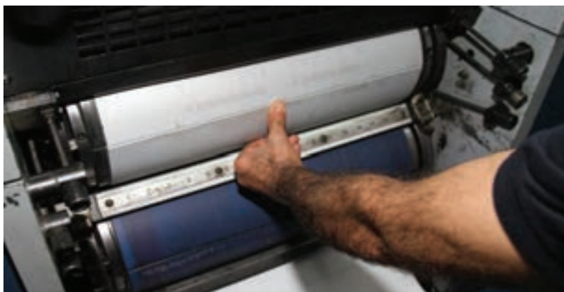
شکل ۷۱- قرارگیری ته کار پلیت در شیار سیلندر
