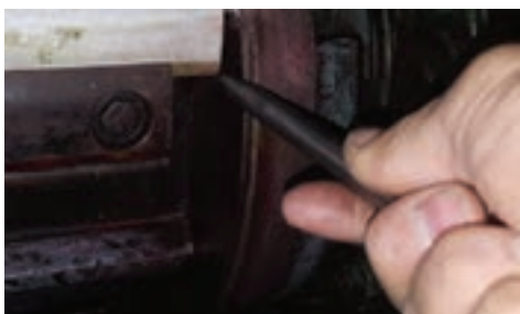
شکل ۸۲- پیچ تنظیم عرضی گیره
