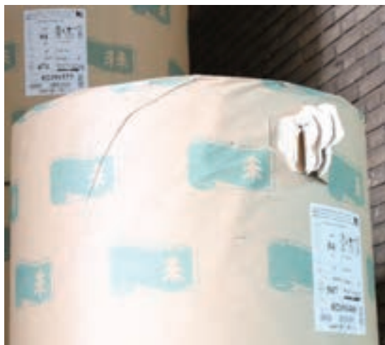
شکل ۶- خراش و پارگی روی بدنه رول
