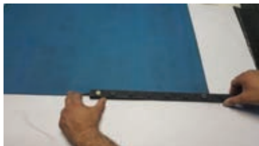
شکل ۵۹- نصب گیره لاستیک
