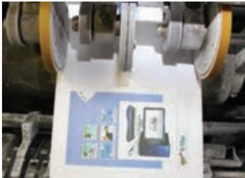
شکل ۳۳- پرفراژ طولی خارج شده از مدار تولید
