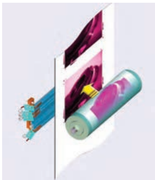
شکل ۳۵- انتقال تصویر روی سطح چاپ شونده
