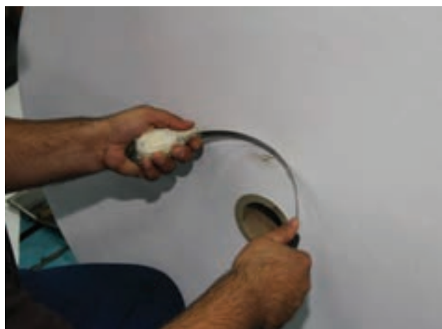
شکل ۵- برطرف کردن آسیب روی بدنه رول
