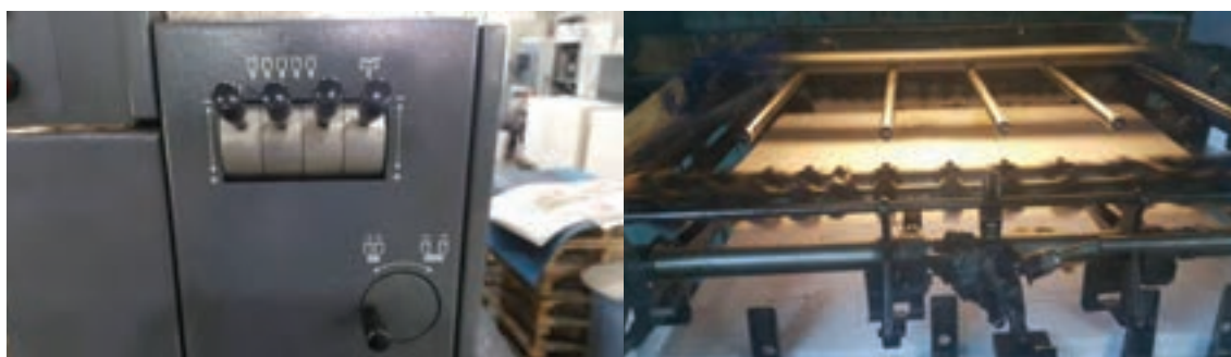
شکل ۴۸- دستگیره‌های تنظیم دمنده
