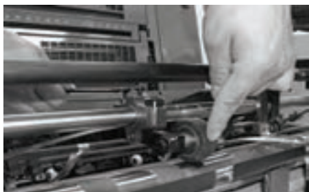
شکل ۳۲- تنظیم فشار قرقره
