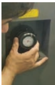
شکل ۳۸- گیج تغییر زاویه سیلندر ترانسفر
