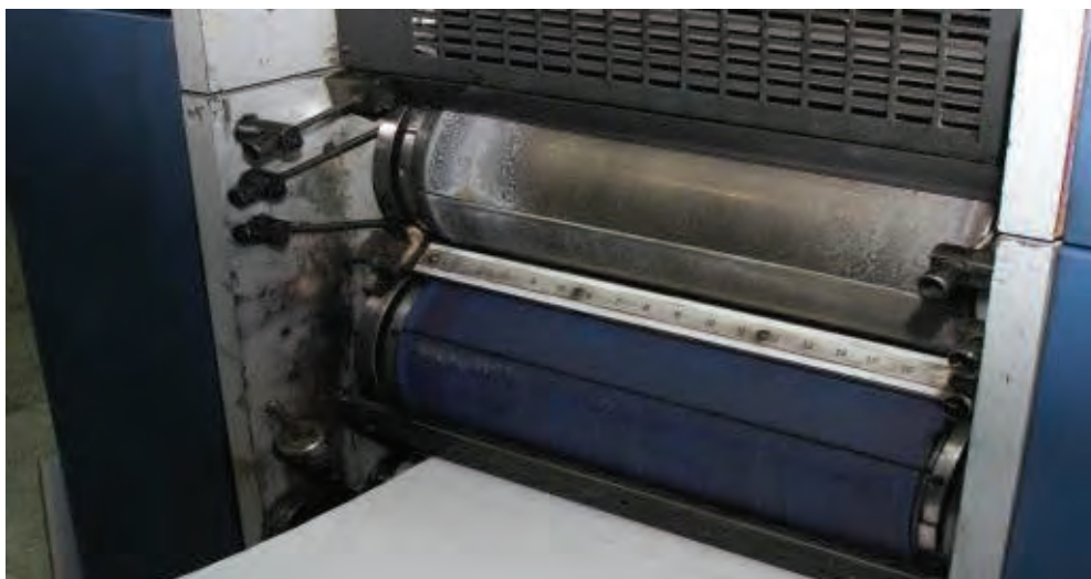
شکل ۶۸- سیلندر آماده بستن پلیت
