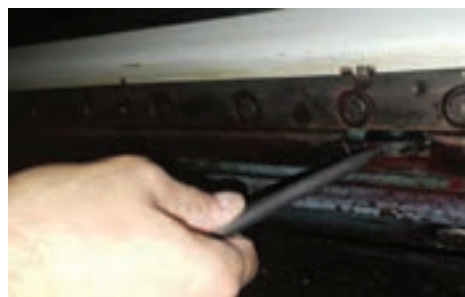
شکل ۸۱- پیچ تنظیم لبه کار
