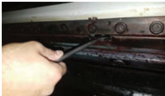
شکل ۸۴- پیچ تنظیم گیره
