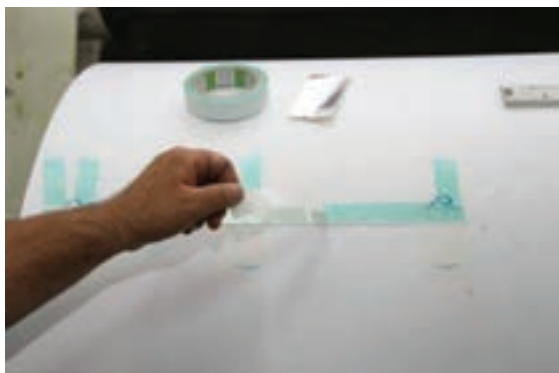
شکل ۲۳- برداشتن روکش چسب
