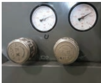
شکل ۴۲- شیر تنظیم مکش (شیر سمت چپ)
