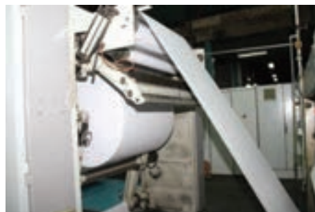
شکل ۹- سیستم عملکرد تغذیه بدون توقف (Splicer)
