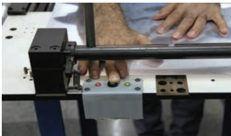
شکل ۶۰- حسگرهای لب کار پلیت
