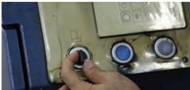
شکل ۵۲- کلید آزاد کردن سیلندرها
