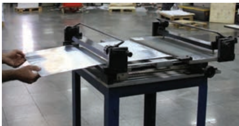
شکل ۶۲- قرار دادن پلیت در دستگاه خم‌کن
