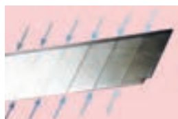
شکل ۱-۸- شیارهای روی تیغه کاتر
