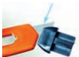
شکل ۱-۱۰- روش شکستن تیغه کاتر با قطعه انتهایی دسته آن
