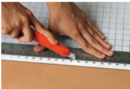
شکل ۴۰-۱- روش برش لبه اضافی کاغذ با کاتر
