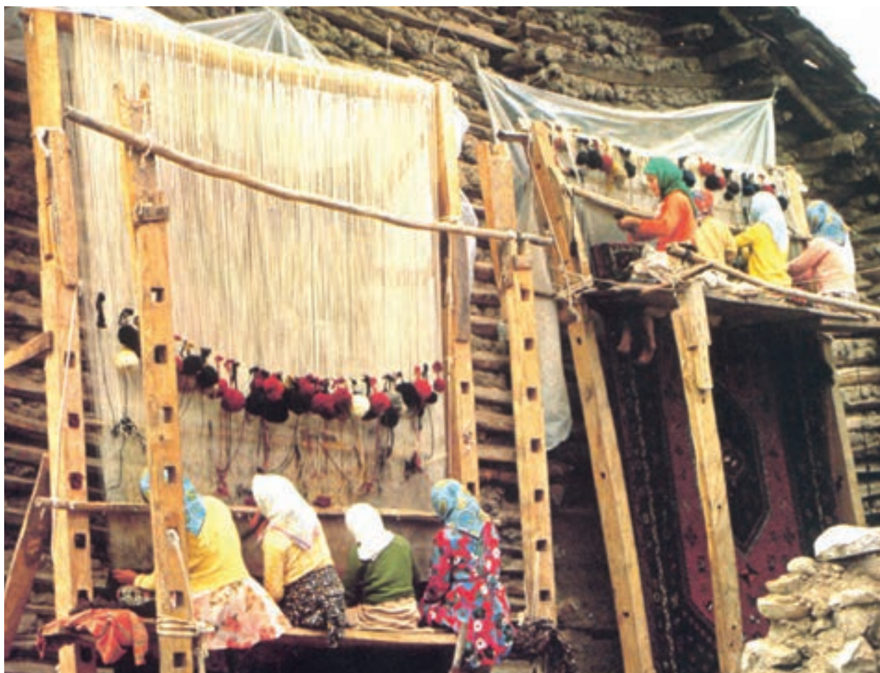
تصویر ۱۰-۱ ▲ بافندگان در حال بافت بر روی دار بدون حفاظ (احتمال خطر افتادن)
