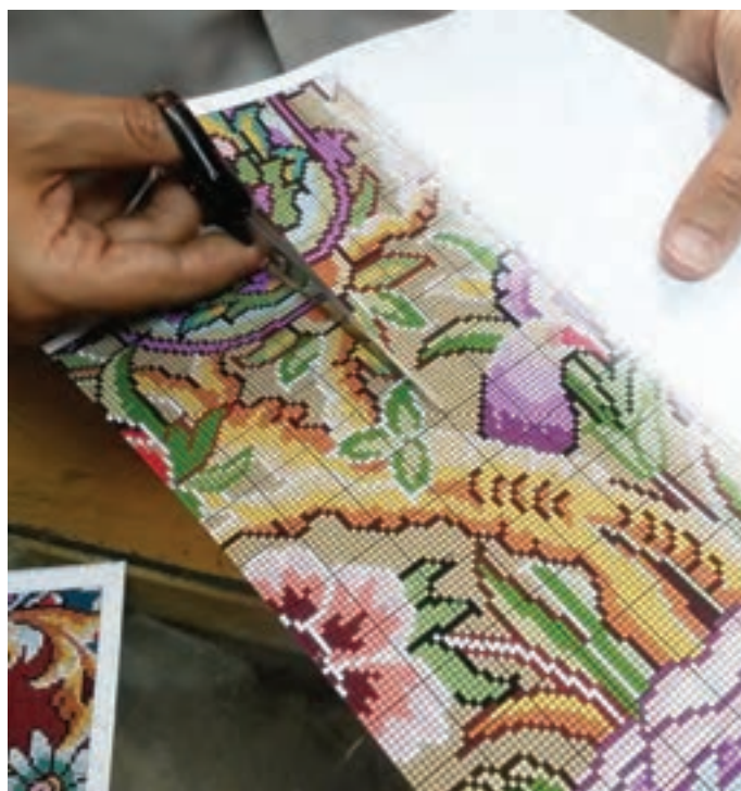
شکل ۴-۵- برش نقشه با قیچی (روش غلط)
