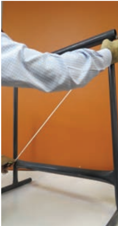
تصویر ۱-۱۳ ▲ اندازه گیری فاصله دو سر پایینی راست روها
