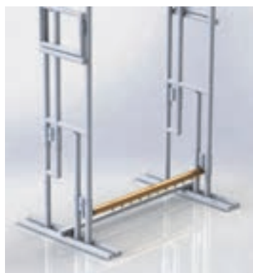
شکل ۵۸-قرار دادن تیر پایین
