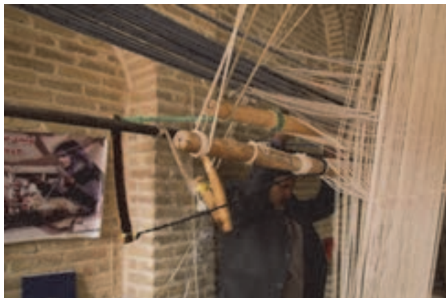
شکل ۳۳- شمشیه‌ها در دستگاه زیلوبافی
