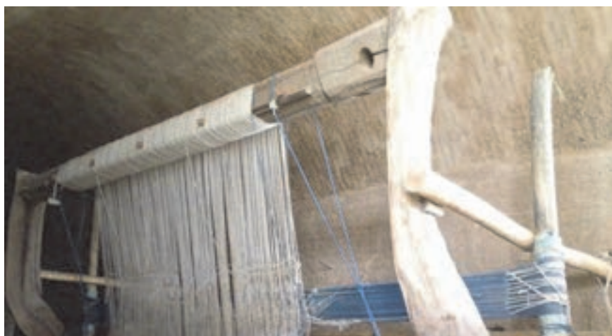
شکل ۳۰- تیر بالا در دستگاه زیلوبافی
