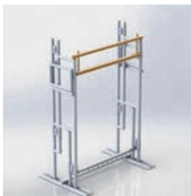
شکل ۵۹-قرار دادن مهار بالای جلو
