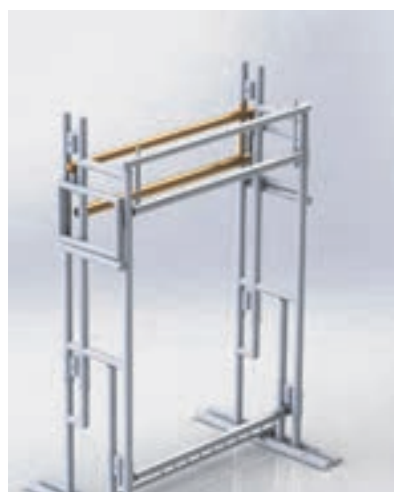
شکل ۶۰-قرار دادن مهار بالا
