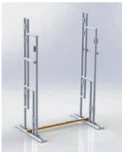
شکل ۵۷-قرار دادن مهار پایین
