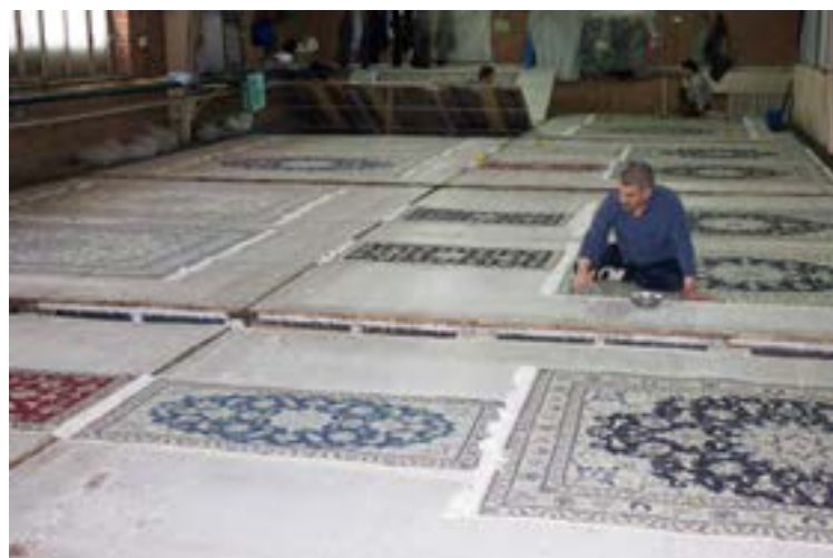
تصویر ۴- دارکشی با میخ و چنگک ▲
