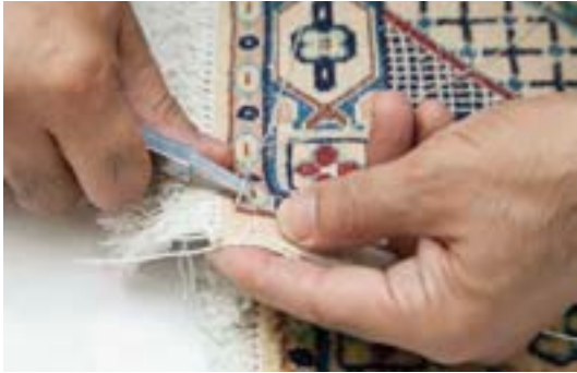
تصویر ۴۴- محل ورود و خروج سوزن هنگام دوخت ▲
