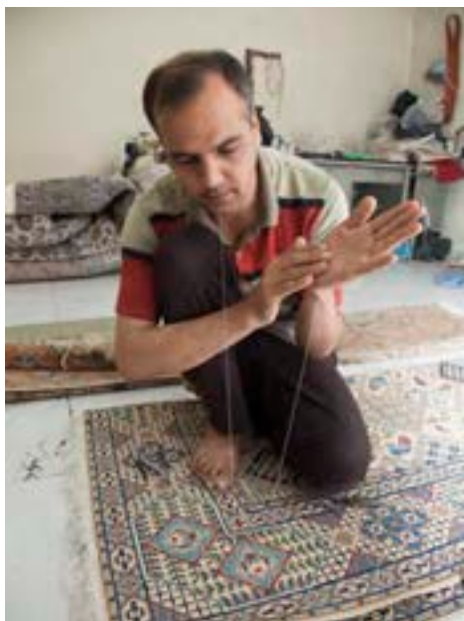
تصویر ۴۱- حرکت دست‌ها برای باز کردن تاب نخ ▲
