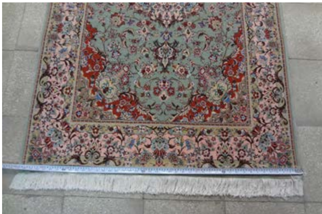
تصویر ۱۳- اندازه‌گیری عرض پایین قالی با متر ▲
