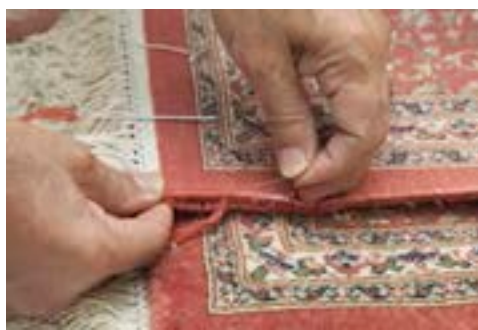
تصویر ۳۰- وارد کردن سوزن در رج بعدی ▲
