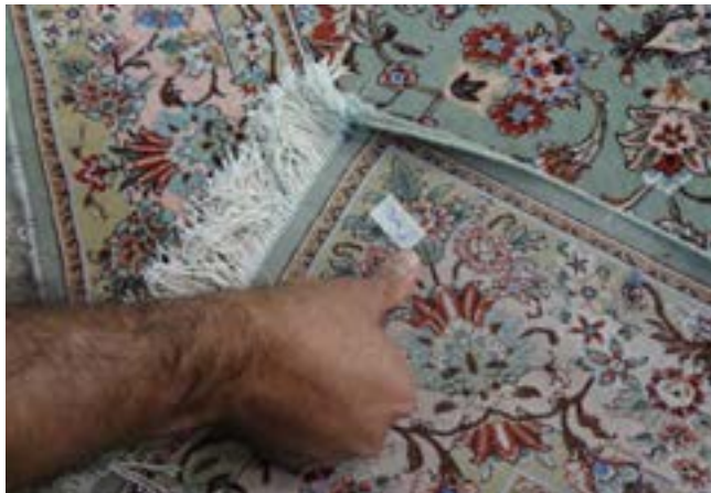
تصویر ۱۰- مشخص کردن میزان کجی در پشت قالی ▲
