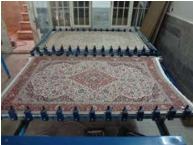
تصویر ۲۳- کشش عرضی فرش و خشک کردن بوسیله کباب پز مرحله ۷ ▲
