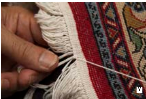
▲ تصویر ۱۷- نحوه دوگره زنی در صورت پاره شدن نخ
