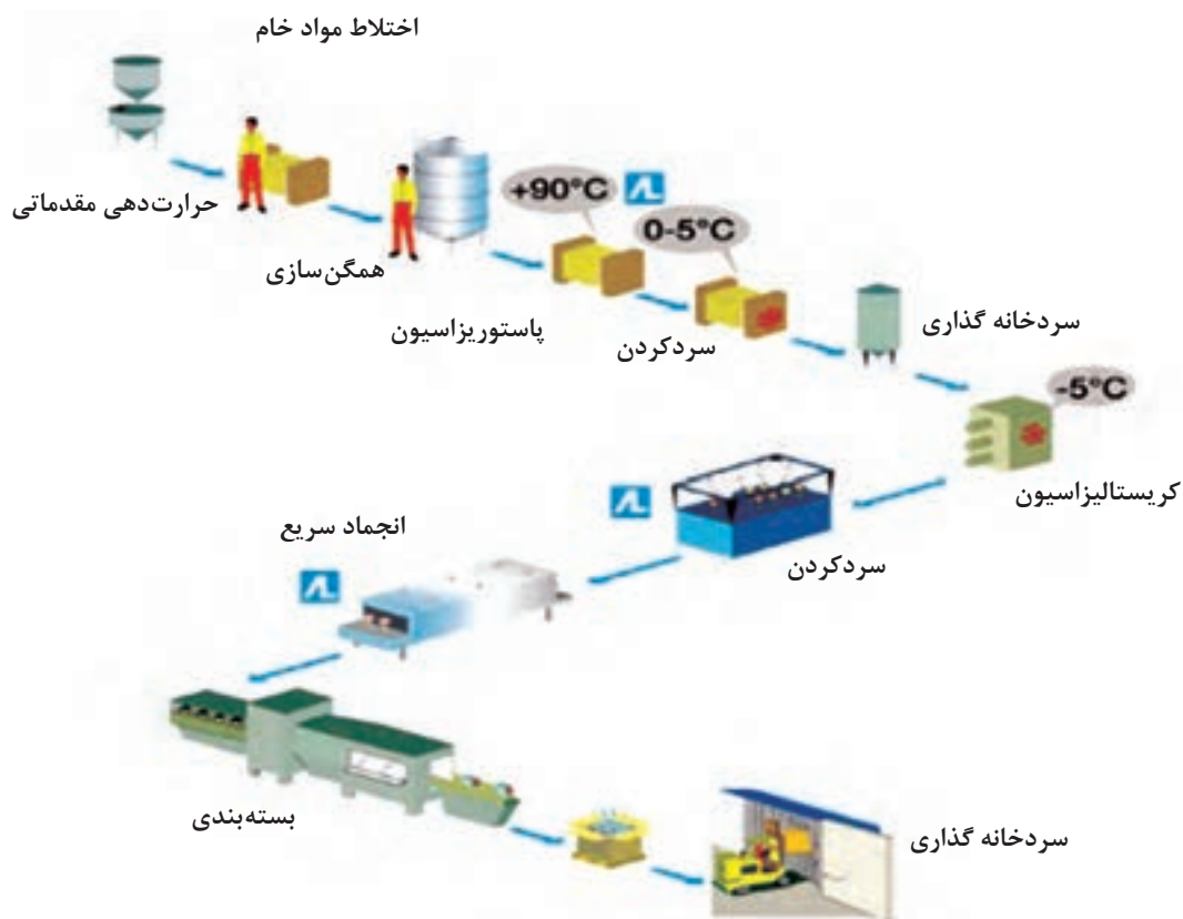
شکل ۳-۸ - فرایند تولید بستنی
