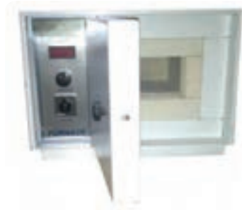
شکل ۲-۱۶- وسایل مورد استفاده برای آزمایش اندازه‌گیری خاکستر
