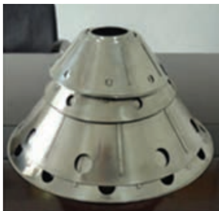
شکل ۵-۶- سپراتور و صفحات داخلی آن
