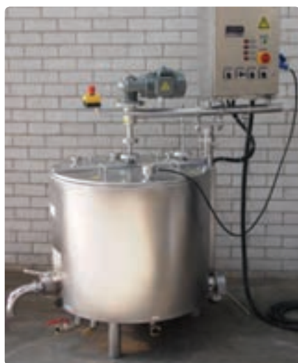
شکل ۱-۱۷- سیستم پاستوریزاسیون غیرمداوم
