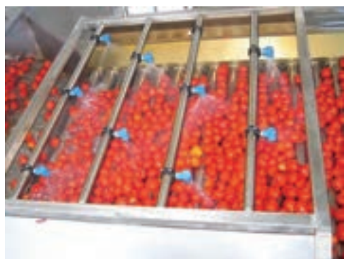
شکل ۶- شست‌وشو با پاشش آب
