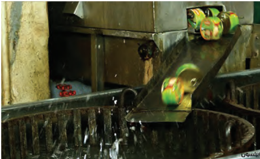
شکل ۲- وارد شدن قوطی‌های فلزی به سبدهای اتوکلاو
