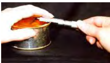
شکل ۴- اندازه‌گیری عرض دوخت
