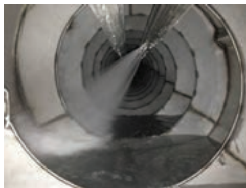
شکل ۵- شست‌وشوی افشانی با استوانه گردان
