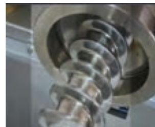
شکل ۱۰- مارپیچ اکسترودر
