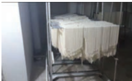
شکل ۸- خشک کردن رشته‌ها در خشک‌کن
