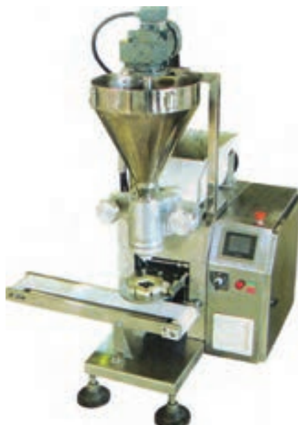
شکل ۳- دستگاه کلوچه زن
