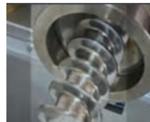
شکل ۱۰- مارپیچ اکسترودر
