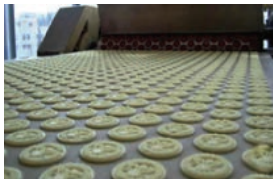
شکل ۷- قالب‌زنی بیسکویت با ماشین قالب‌زن دوار
