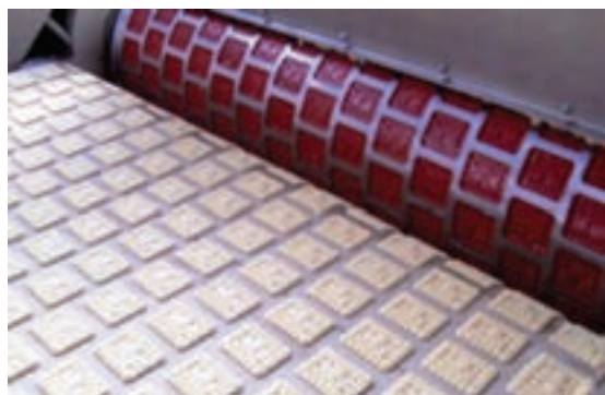
شکل ۷- قالب‌زنی بیسکویت با ماشین قالب‌زن دوار
