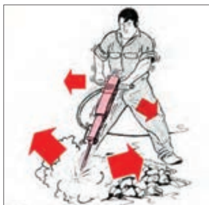
شکل ۳-۲- عوارض ناشی از ارتعاش
