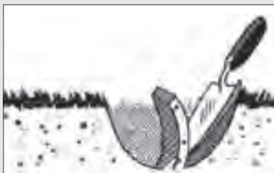
شکل ۱۴-۲ روش برداشت نمونه با بیل یا بیلچه
