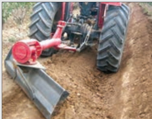
شکل ۲۷-۲- زاویه تیغه و ریزش خاک در چاله
