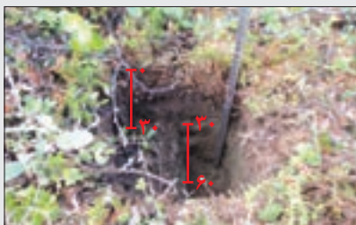
شکل ۱۵-۲ روش نمونه برداری از دو عمق ۳۰ و ۶۰ سانتی‌متر
