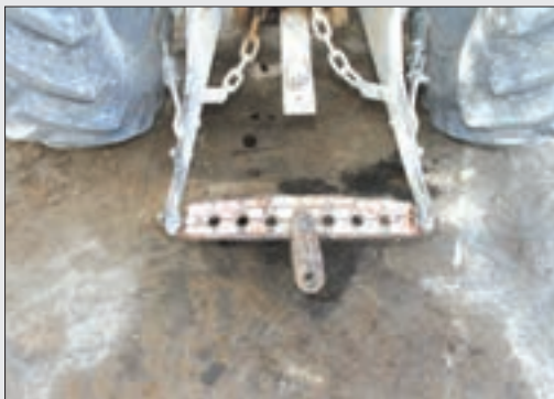
شکل ۲۹-۴- مالبند بلند و اتصال سه نقطه
