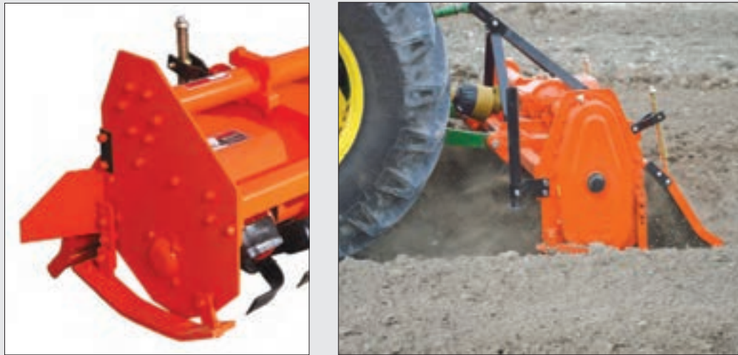
شکل ۴-۴- تنظیم درپوش و عمق کار
