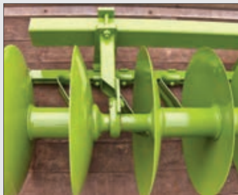
شکل ۲۰-۴- اجزای محور دیسک
