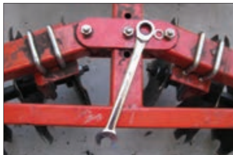
شکل ۲۸-۴- تغییر زاویه استقرار ردیف بشقاب‌ها روی شاسی
