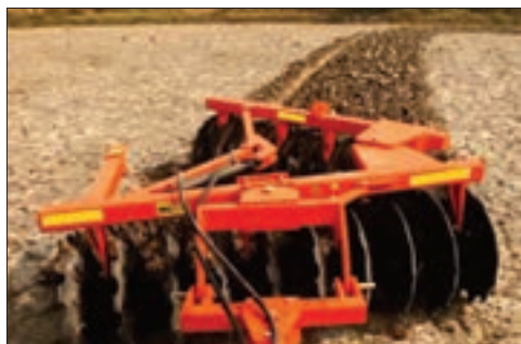
شکل ۲۸-۴- تغییر زاویه استقرار ردیف بشقاب‌ها روی شاسی
