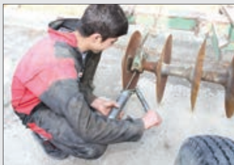
شکل ۲۱-۴- گریس کاری دیسک
