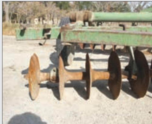
شکل ۱۹-۴- یاتاقان خراب بشقاب
