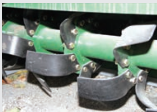
شکل ۲۲-۴- وضعیت درپوش و تیغه‌ها در گاوآهن دوار
