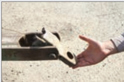
شکل ۱۸-۴- شکستگی نقطه اتصال و بشقاب
