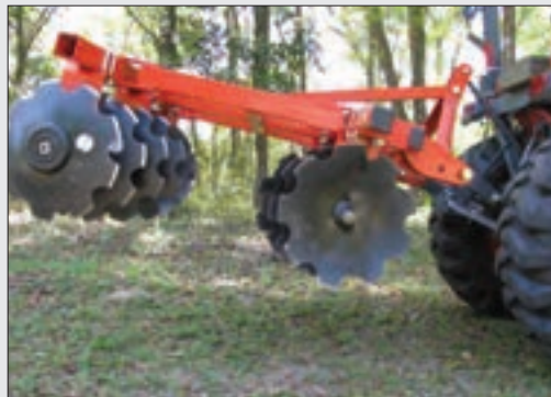
شکل ۲۹-۴- مالبند بلند و اتصال سه نقطه
