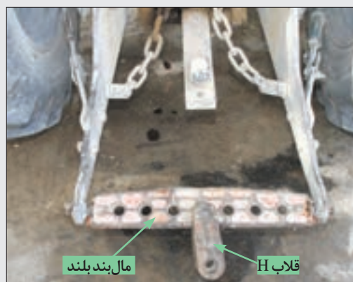
شکل ۱۵-۵- مال بند بلند برای اتصال ماشین هموارکننده نیمه سوار
