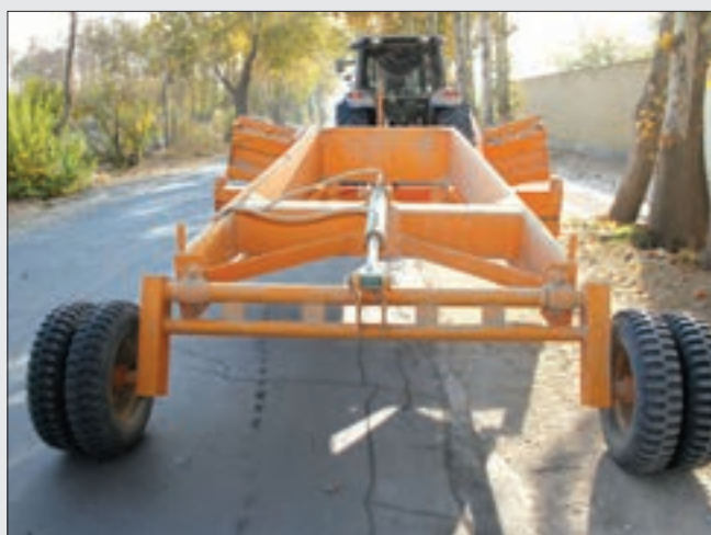
شکل ۱۸-۵- تنظیم وضعیت چرخ ها به روش مکانیکی
