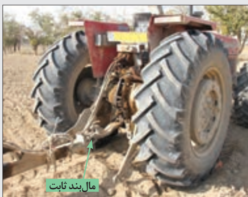
شکل ۱۶-۵- نقطهٔ اتصال در صاف‌کننده کششی
