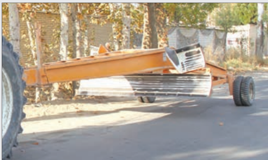
شکل ۱۹-۵- زمین‌صاف‌کن در وضعیت جابه‌جایی
