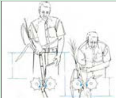
شکل ۲۹-۲- سعی در رفع گیر کردن ماشینی که در حال کار است یک مخاطره شدید محسوب می شود.
