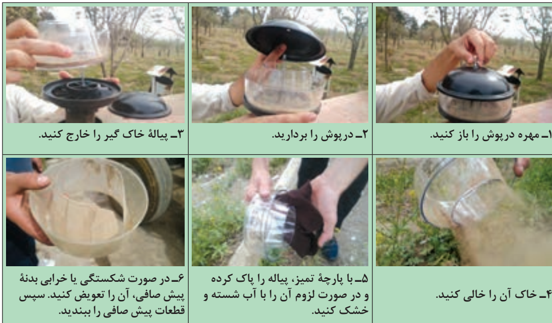
شکل ۳۱-۱- مراحل تمیز کردن پیش صافی
