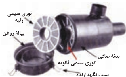
شکل ۲۶-۱- اجزای تشکیل دهنده صافی روغنی
