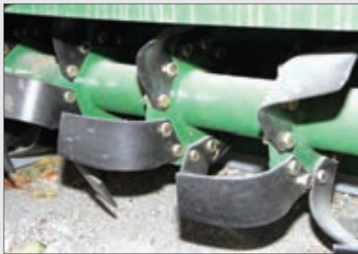
شکل ۲۲-۴- وضعیت درپوش و تیغه‌ها در گاوآهن دوار
