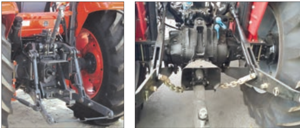
شکل ۳۲-۳- زنجیر تنظیم تعادل یا نوسان گیر
