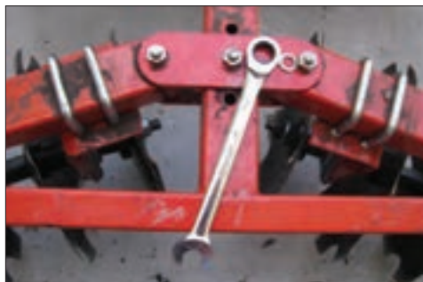
شکل ۲۸-۴ تغییر زاویه استقرار ردیف بشقاب‌ها روی شاسی
