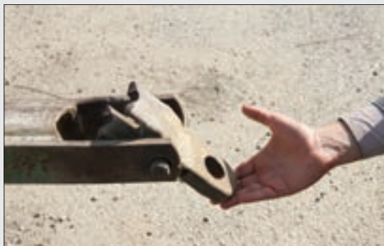
شکل ۱۲-۵- شکستگی نقطه اتصال صاف کننده
