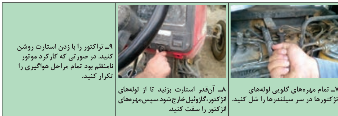
شکل ۴۰-۱- مراحل هواگیری سیستم سوخت رسانی
