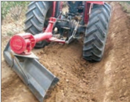
شکل ۲۷-۲- زاویه تیغه و ریزش خاک در چاله
