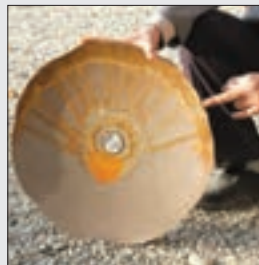
شکل ۱۸-۴- شکستگی نقطه اتصال و بشقاب
