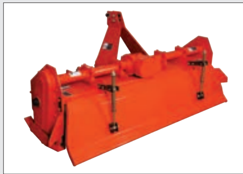
شکل ۲۲-۴- وضعیت درپوش و تیغه‌ها در گاوآهن دوار
