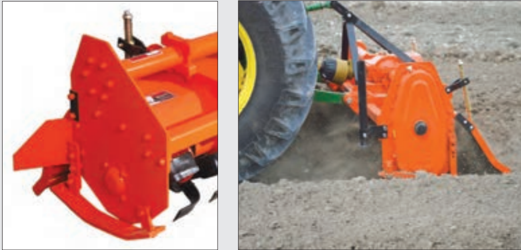
شکل ۴-۴- تنظیم درپوش و عمق کار
