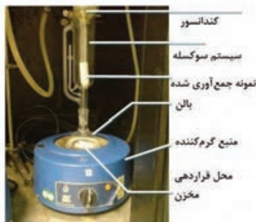
شکل ۶۰- دستگاه سوکسله بر روی هیتر
