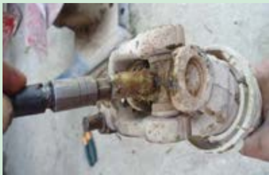
شکل ۱۵- گریس کاری گاردان و بذریاش
