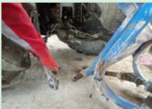
شکل ۸- اتصال بذرپاش به بازوهای کناری تراکتور
