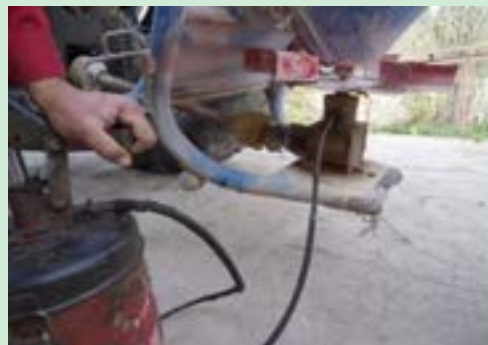
شکل ۱۵- گریس کاری گاردان و بذریاش
