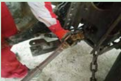
شکل ۹- نصب گاردان بین بذرپاش و تراکتور
