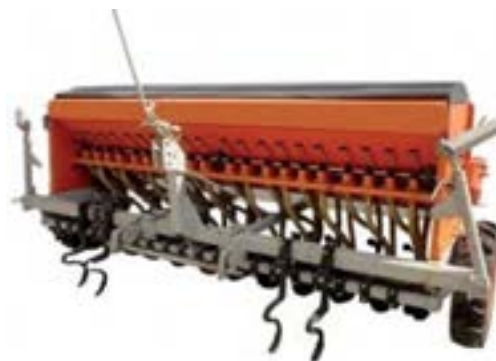
شکل ۴- خطی کار جهت کاشت غلات با قابلیت تنظیم جهت کاشت ریز دانه
