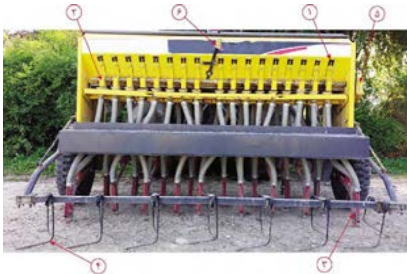
شکل ۷- ساختمان خطی کار از عقب دستگاه
