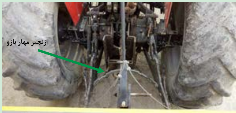
شکل ۱۴ - زنجیر مهار بازوی تراکتور
