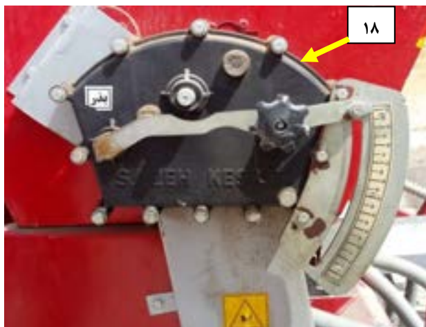
شکل ۳۸- جعبه دنده تنظیم ریزش بذر
