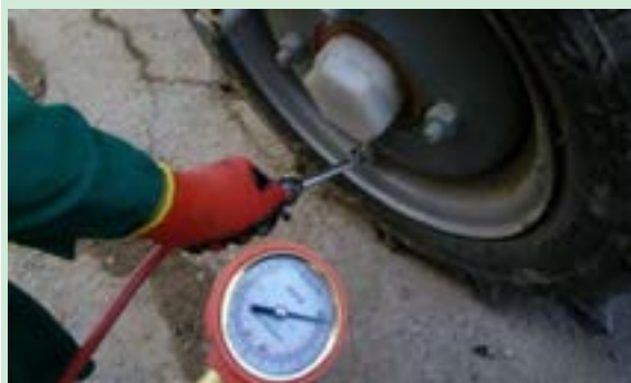
شکل ۴۴- تنظیم باد چرخ‌های دستگاه
