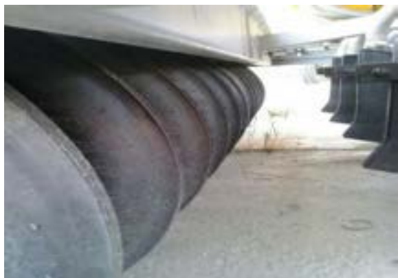
شکل ۵۵- چرخ‌های فشار دهنده بوشورت به هم پیوسته
