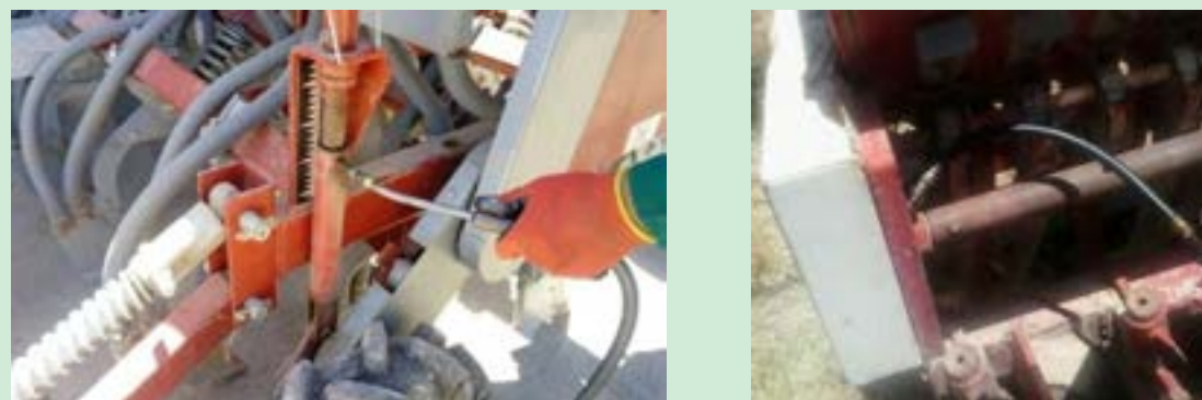
شکل ۴۲- برخی از گریس خورهای کارنده‌های دیم. گریس خورها برحسب دستگاه تفاوت دارند. اغلب کلاج گیربکس دارند، چرخ جلو، یاتاقان‌های چدنی، و سامانه تنظیم کارنده‌ها دارای گریس خور هستند.
