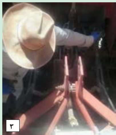
شکل ۴۸- ابتدا اتصال بازوی چپ سپس بازوی سمت راست، چهارشاخ گاردان و نهایتاً بازوی وسط
