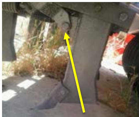
شکل ۵۴- سوراخ روی بازوی بیلچه شیار بازکن
