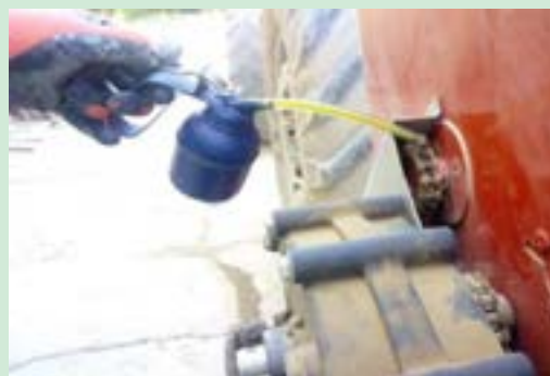
شکل ۴۳- روغن کاری چرخ دنده‌ها
