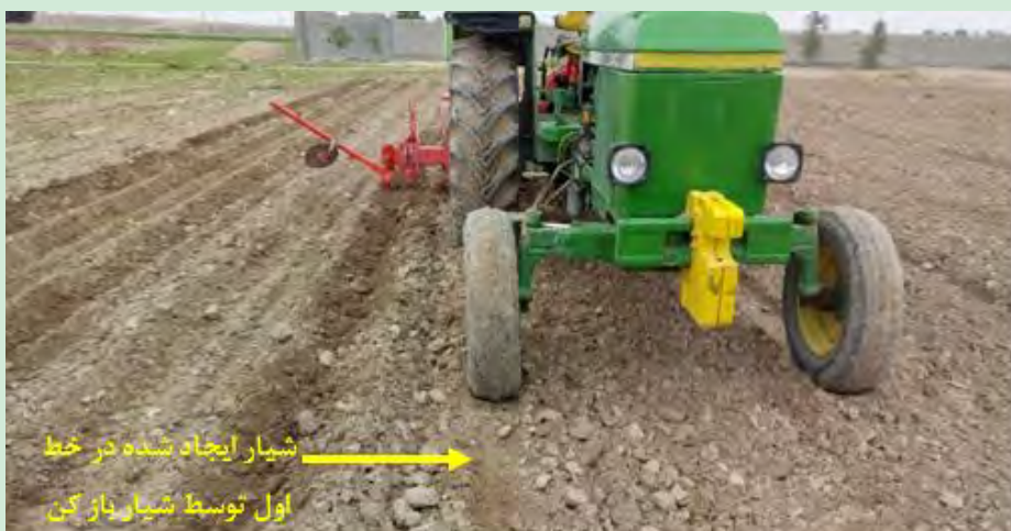
شکل ۲۸- عملیات کاشت در حالت برگشت
