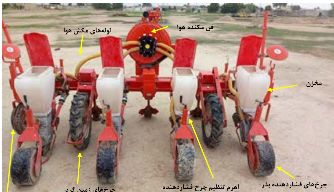
شکل ۷- ساختمان ردیف‌کار پنوماتیکی بدون کودکار از عقب دستگاه
