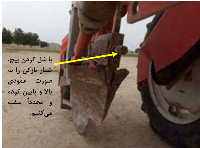
شکل ۲۰- تنظیم شیار بازکن
