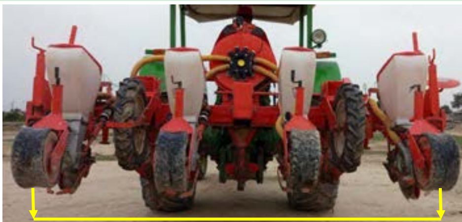
شکل ۱۶ - فاصله دوتا چرخ انتهایی تا سطح زمین بر حسب سانتی‌متر باید به یک اندازه باشد
