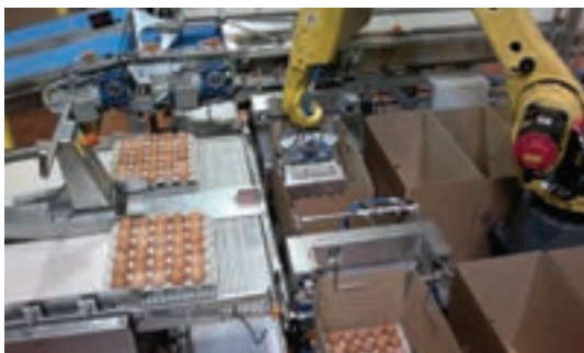
روش انتقال تخم‌مرغ‌ها به صورت تمام خودکار در این روش با استفاده از دستگاه خودکار مخصوص تخم‌مرغ‌ها از شانه‌های ستر به سبدها منتقل می‌شوند.
