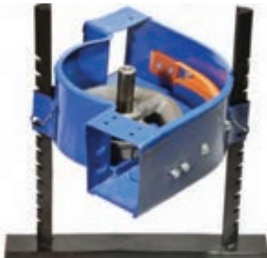
مخزن دان (هاپر) و الکتروموتور
