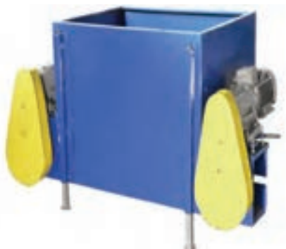
مخزن دان (هاپر) و الکتروموتور
