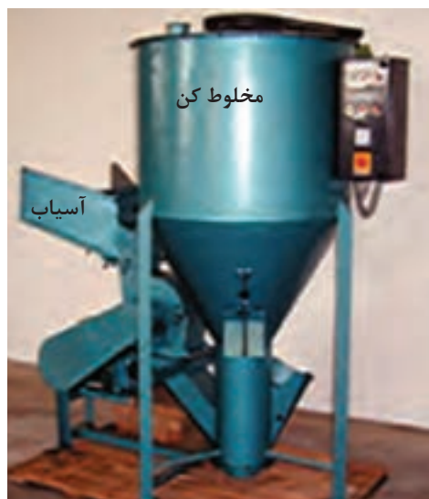
دستگاه آسیاب و مخلوط کن عمودی
