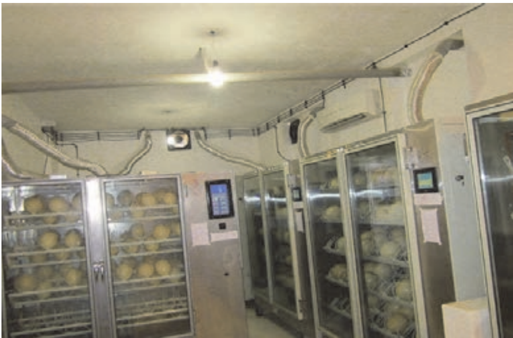
دستگاه ستر مخصوص شترمرغ در سالن جوجه‌کشی
