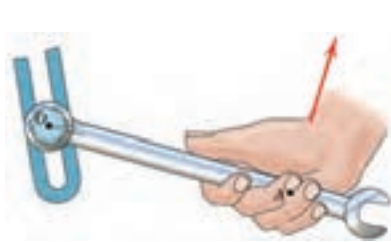
شکل ۳۱-۴- روش‌هایی برای پیچاندن قطعه
