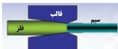
شکل ۲۵-۵- تولید سیم به روش کشش
