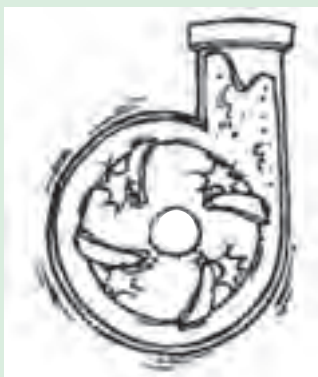
شکل ۲۹-۵. کاویتاسیون در پروانه پمپ
