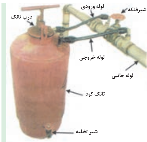
شکل ۴۹-۵. اجزای سیستم توزیع کود
