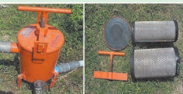
شکل ۵۷-۵. قطعات باز شده صافی توری
