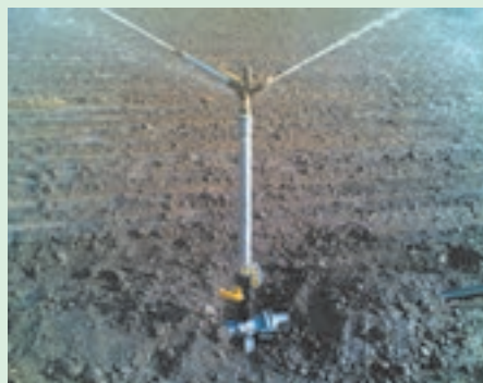
شکل ۴۱-۵. آبپاش مستقر شده روی شیر خودکار
