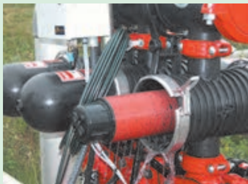
شکل ۶۰-۵. شست و شوی دستی صافی دیسکی
