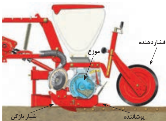
شکل ۱۴-۳. اصول کاشت بذر با کارنده
