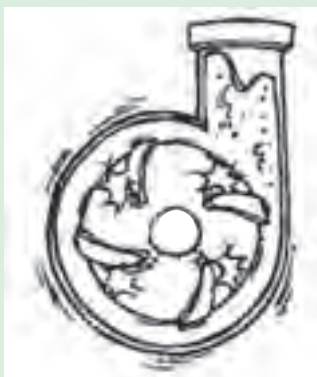
شکل ۲۹-۵. کاویتاسیون در پروانه پمپ
