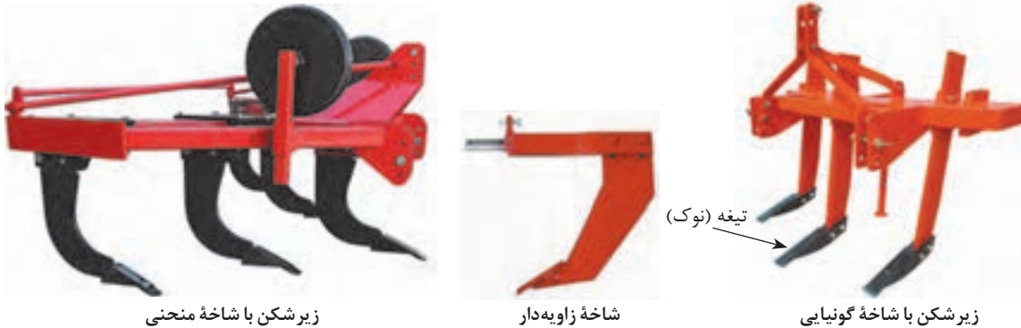
شکل ۱۲-۱. زیرشکن و انواع شاخه‌های آن
