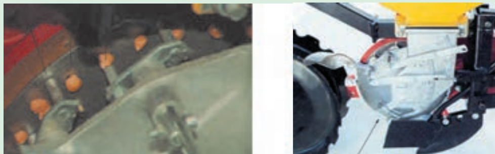
شکل ۳۶-۳. تنظیم تک‌دانه‌کن در ردیف‌کار نیوماتیکی
