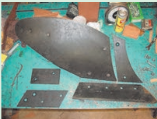
شکل ۲۰-۱. چیدمان اجزای بازشده خیش در کنار یکدیگر
