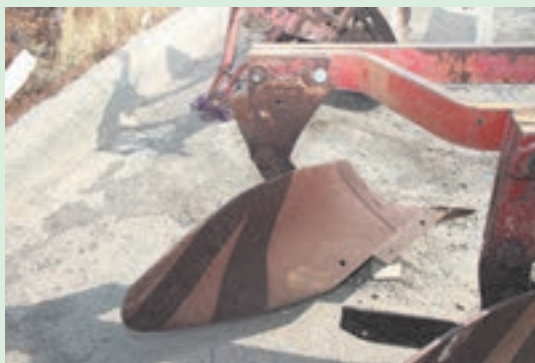
شکل ۲۱-۱. پین بریده شده در گاواهن
