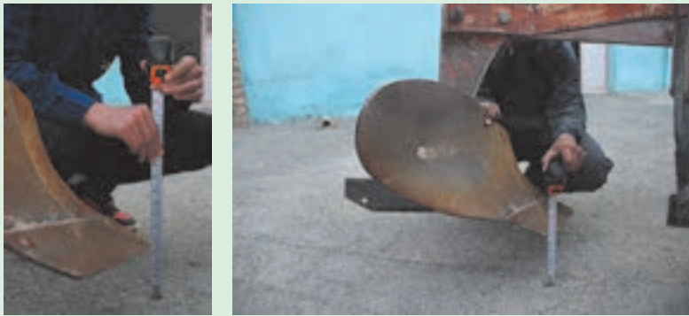
شکل ۳۰-۱. اندازه‌گیری فاصله تیغه جهت تراز عرضی
