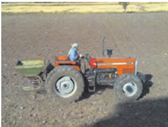
شکل ۲-۳. پاشیدن بذر و زیر خاک کردن آن با ماشین
