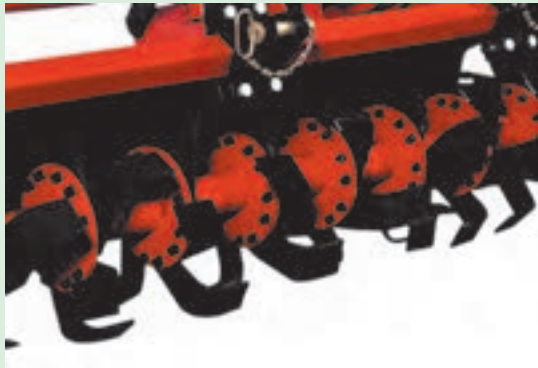
شکل ۲۲-۱. نقاط اتصال تیغه‌ها به فلانچ
