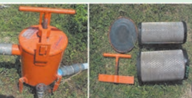
شکل ۵۷-۵. قطعات باز شده صافی توری
