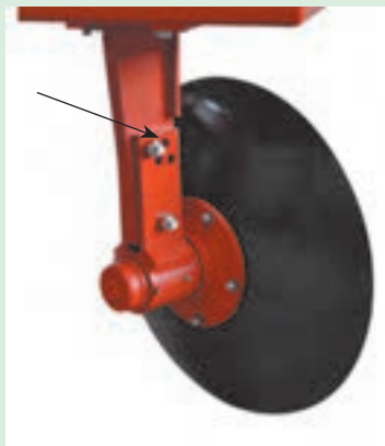
شکل ۴۲-۲. تنظیم زاویه بشقاب
