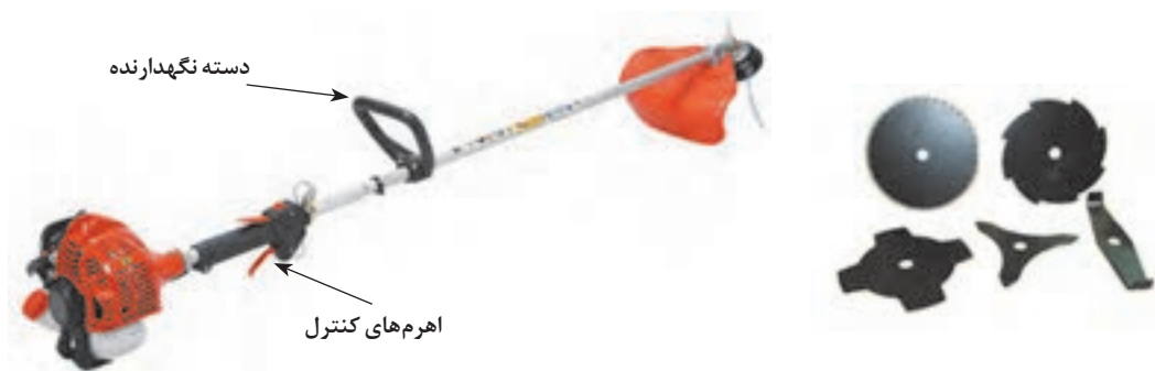
شکل ۵۰-۴. علف‌زن موتوری و تیغه‌های آن
