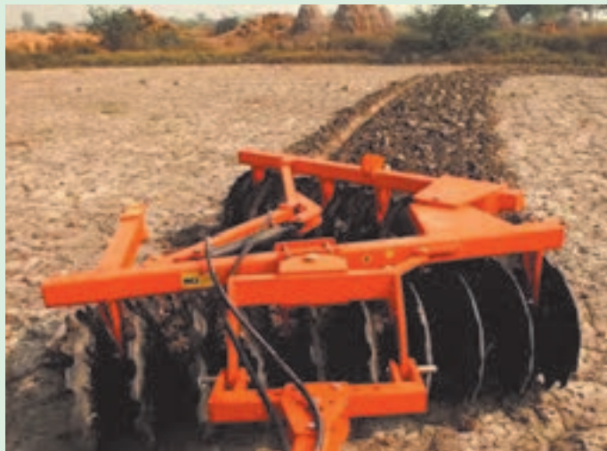
الف. تنظیم زاویه برش به وسیله جک
