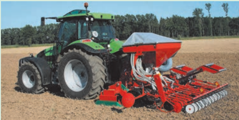
شکل ۱۱-۳. کمبینات (خطی کار مرکب)
