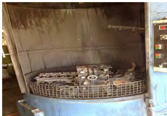
شکل ۶۱. شستشوی موتور به وسیله دستگاه شات بلاست
