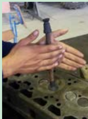
شکل ۷۹. چرخاندن سوپاپ به وسیله چوب سوپاپ گردان
