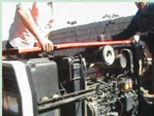
شکل ۴۰. برداشتن کاپوت تراکتور MF۳۹۹
