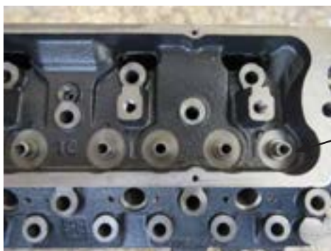
شکل ۱۶. گیت سوپاپ
