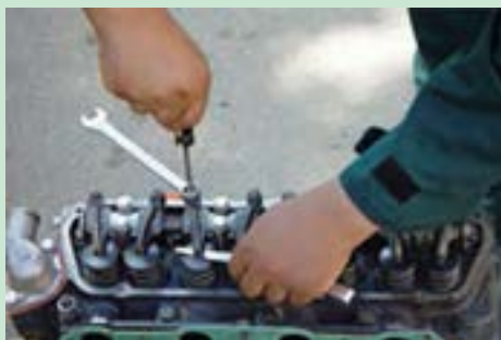
شکل ۳۶. فیلرگیری
