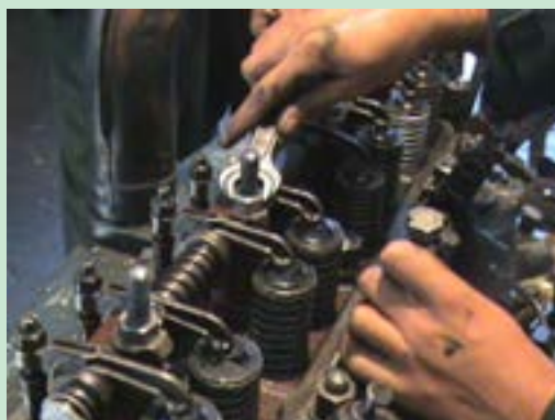
شکل ۴۵. باز کردن پیچ‌های پایه اسبک
