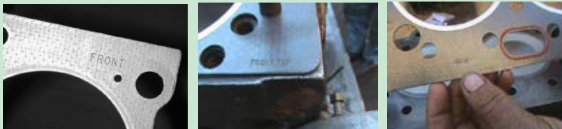
شکل ۸۶. علامت های روی واشر سرسیلندر
