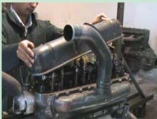
شکل ۴۴. برداشتن درپوش سوپاپ‌های تراکتور U650
