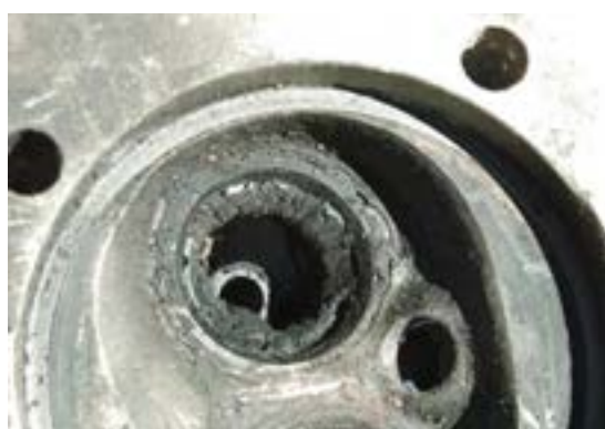
شکل ۶۷. کربن گرفتگی سرسیلندر و سوپاپ‌ها
