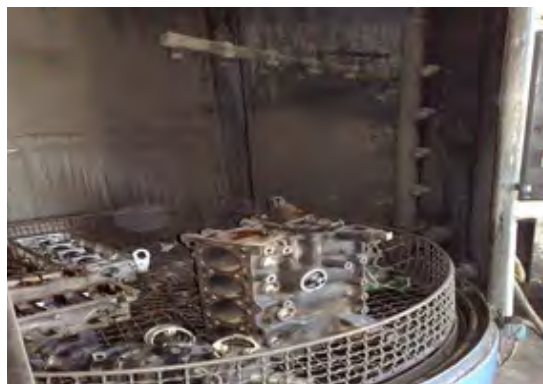
شکل ۶۱. شستشوی موتور به وسیله دستگاه شات بلاست
