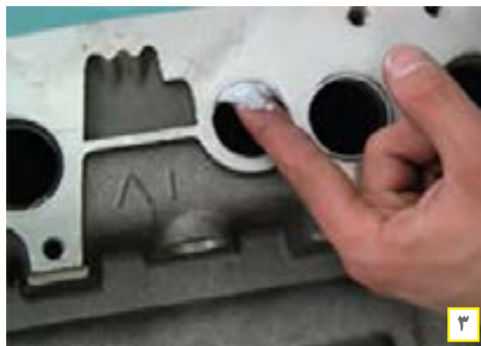
شکل ۶۹. روش تعویض پولک سر سیلندر
