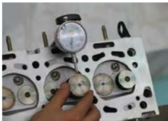
شکل ۷۳. روش کنترل لقی بین سوپاپ و گیت
