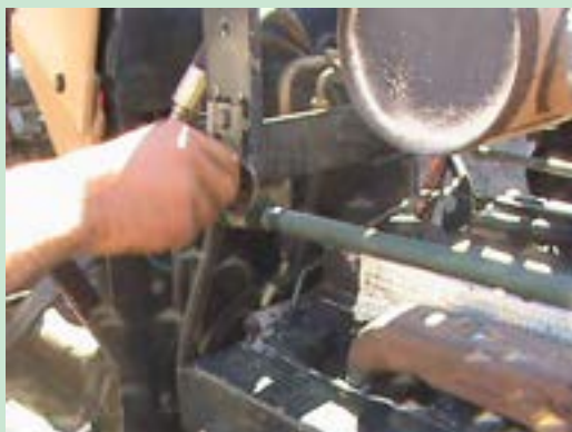
شکل ۴۱- باز کردن انباره اگزوز تراکتور MF۳۹۹
