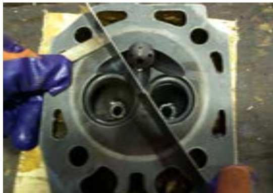
شکل ۶۵. کنترل تابیدگی سرسیلندر تراکتور دوچرخ
