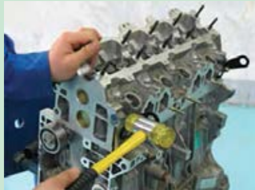
شکل ۴۹. آزاد کردن چسبیدگی سر سیلندر
