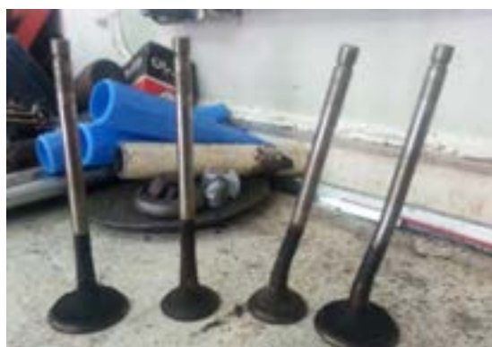
شکل ۶۷. کربن گرفتگی سرسیلندر و سوپاپ‌ها
