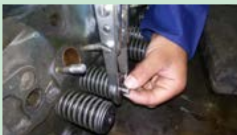
شکل ۵۸. قرار دادن فنر جمع کن و خار کردن خار سوپاپ
