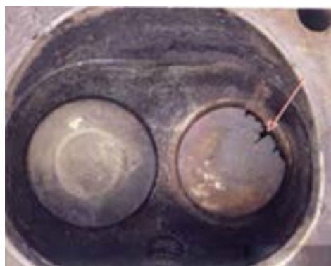
شکل ۷۰. عیوب ظاهری سوپاپ‌ها
