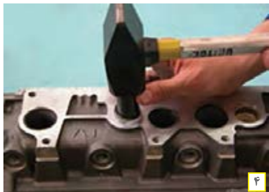
شکل ۶۹. روش تعویض پولک سر سیلندر
