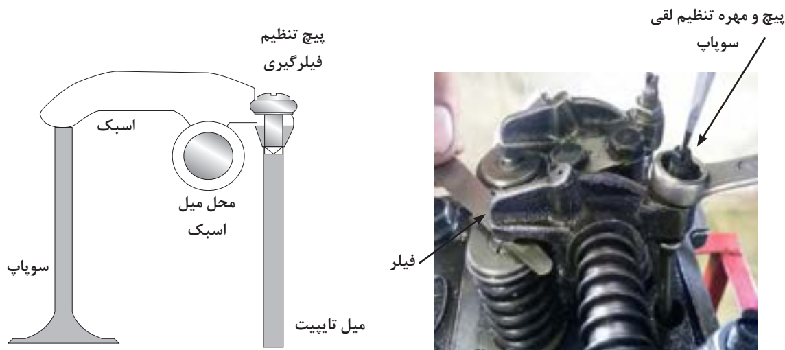
شکل ۳۲. پیچ و مهره تنظیم لقی سوپاپ
