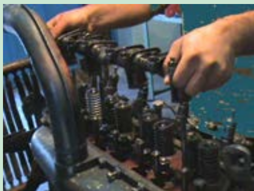
شکل ۴۶. برداشتن مجموعه اسبک از روی سرسیلندر
