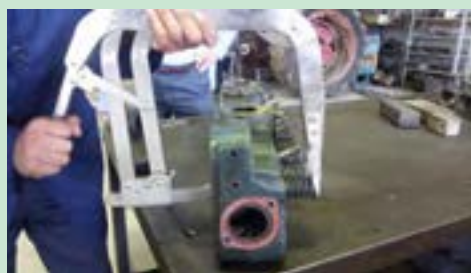
شکل ۵۸. قرار دادن فنر جمع کن و خار کردن خار سوپاپ
