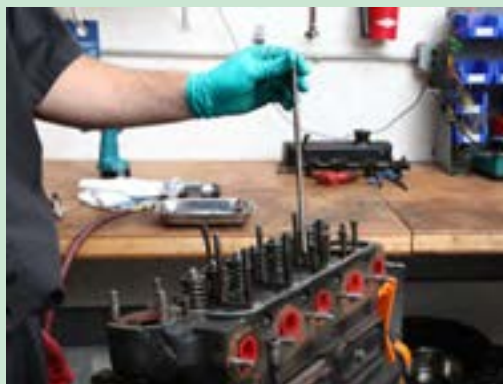
شکل ۴۷. خارج کردن میل تپت‌ها
