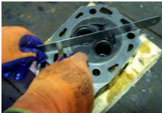
شکل ۶۵. کنترل تابیدگی سرسیلندر تراکتور دوچرخ
