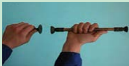
شکل ۷۷. اتصال سوپاپ به چوب سوپاپ گردان
