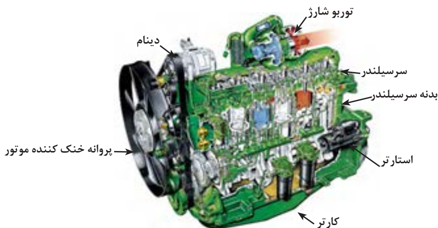
شکل ۷. بعضی اجزای یک موتور دیزل
