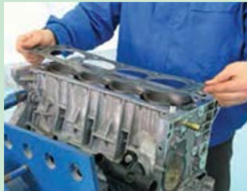
شکل ۵۰. برداشتن واشر سر سیلندر
