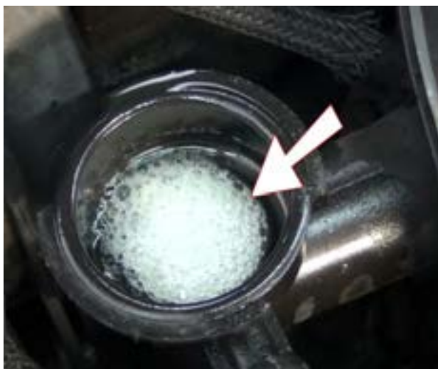
شکل ۳۳. خروج حباب از رادیاتور
