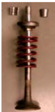
شکل ۱۷. فنر، کلاهک و خار سوپاپ
