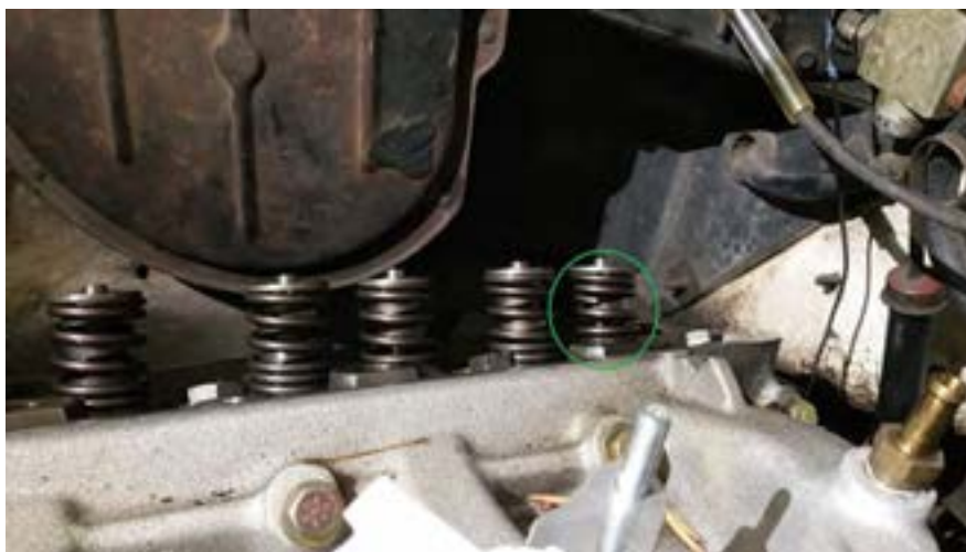
شکل ۷۱. شکستن فنر سوپاپ
