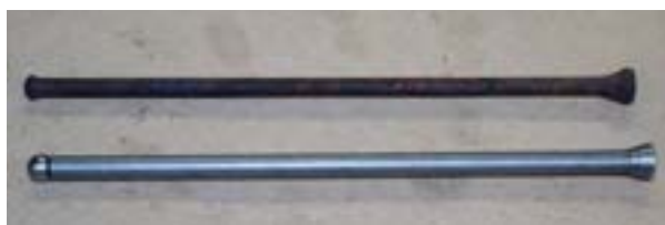
شکل ۷۶. زنگ زدن و شکستگی میل تپت
