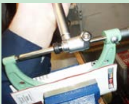
شکل ۷۶. اندازه‌گیری قطر سیلندر با میکرومتر داخلی
