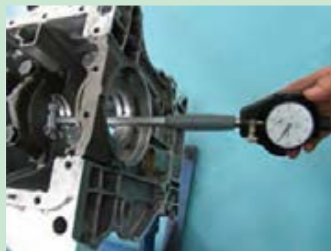
شکل ۶۳. کنترل دو پهنی تکیه گاه های میل لنگ
