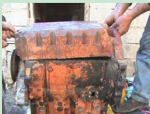
شکل ۱۱۵. نصب کارتر روی بلوکه سیلندر
