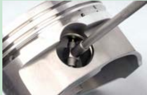
شکل ۸۱. اندازه گیری لقی گژن بین در پیستون
