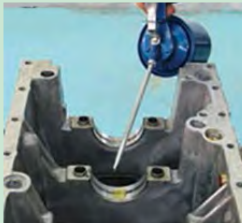
شکل ۹۵. روغنکاری یاتاقان ها قبل از نصب
