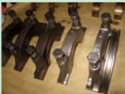
شکل ۴۸. برداشتن کپه‌های یاتاقان و چیدن آنها
