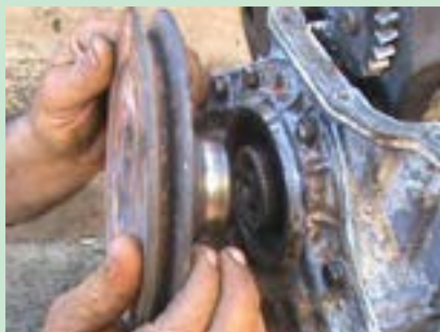
شکل ۳۵. پیاده کردن پولی میل لنگ
