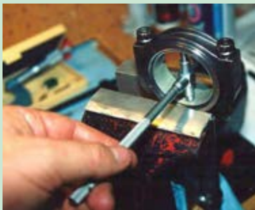
شکل ۸۳. کنترل بیضی شدن سر بزرگ شاتون
