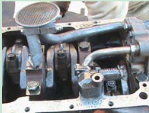
شکل ۱۰۴. بستن صافی و پایه سوپاپ فشار پمپ روغن
