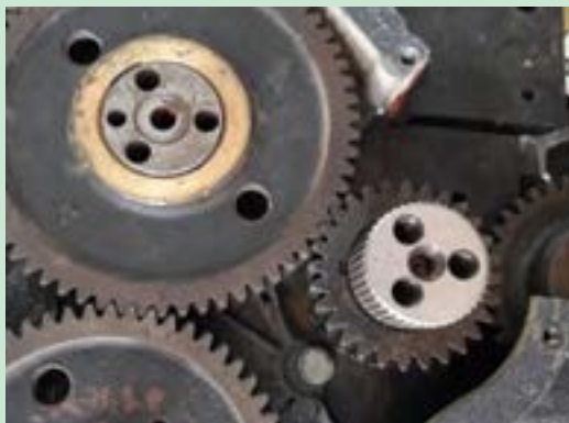
شکل ۱۰۹. علامت‌های تایمینگ روی چرخ دنده ها
