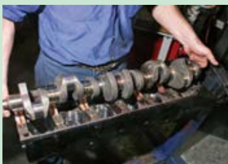
شکل ۴۹. برداشتن میل لنگ
