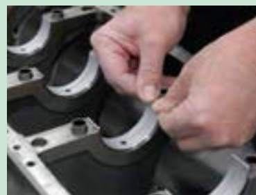
شکل ۸۵. نصب یاتاقان ها روی تکیه گاه های میل لنگ و کپه ها
