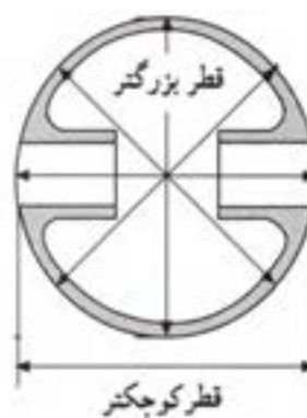
شکل ۷. اندازه قطرهای پیستون
