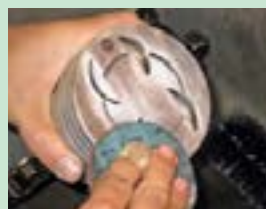
شکل ۵۷. روش های تمیز کردن رسوبات کربن سطح پیستون
