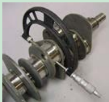
شکل ۸۴. تعیین لقی میل لنگ و یاتاقان های ثابت به وسیله میکرو متر وساعت اندازه گیری
