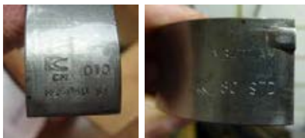
شکل ۲۳. تغییر ضخامت یاتاقان در سایزهای مختلف
