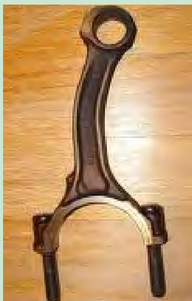
شکل ۸۲. پیچیدگی شاتون، اندازه گیری و اصلاح آن
