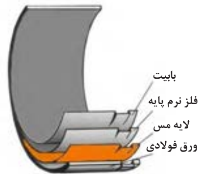
شکل ۱۹. انواع لایه بندی یاتاقان
