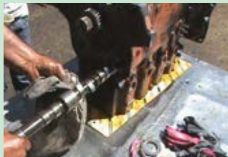
شکل ۹۲. وارد کردن به محل آن در میل سوپاپ در بلوکه سیلندر
