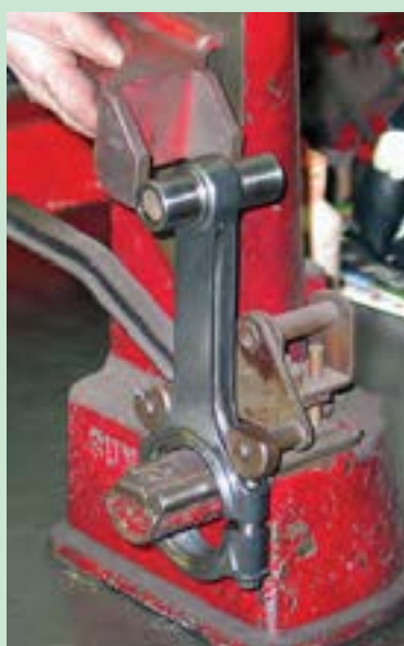
شکل ۸۲. پیچیدگی شاتون، اندازه گیری و اصلاح آن
