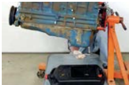
شکل ۳۳. موتور نصب شده روی استند
