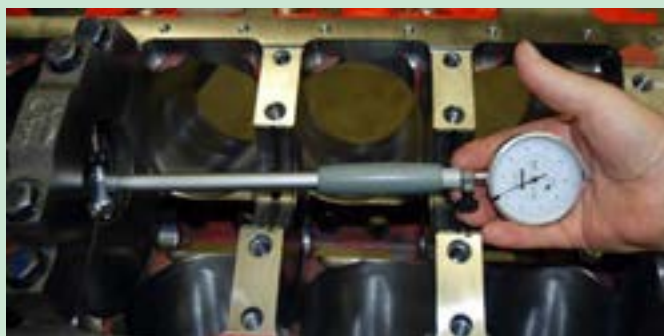
شکل ۸۴. تعیین لقی میل لنگ و یاتاقان های ثابت به وسیله میکرو متر وساعت اندازه گیری
