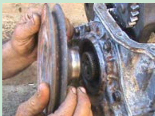
شکل ۱۱۲. جا زدن پولی سر میل لنگ
