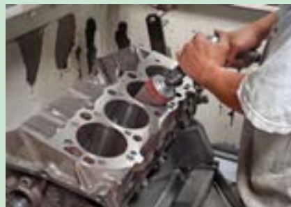
شکل ۳۹. ترمیم لبه بالای سیلندر
