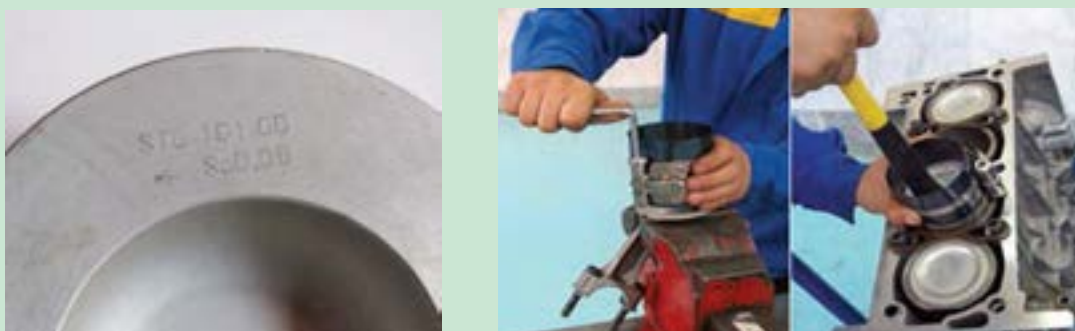
شکل ۹۹. وارد کردن پیستون به داخل سیلندر شکل ۱۰۰. علامت روی پیستون
