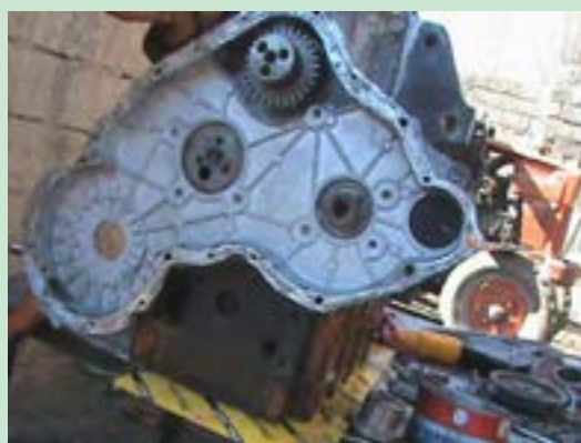
شکل ۱۰۶. چسباندن واشر صفحه پشت چرخ دنده های تایمینگ شکل ۱۰۷. نصب صفحه پشت چرخ دنده های تایمینگ
