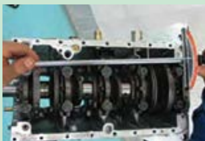
شکل ۴۶. باز کردن پیچ‌های یاتاقان
