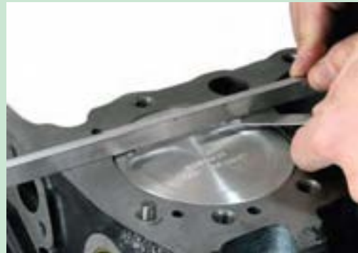
شکل ۱۰۳. کنترل سطح پیستون نسبت به سطح بلوکه سیلندر با فیله و ساعت اندازه گیری
