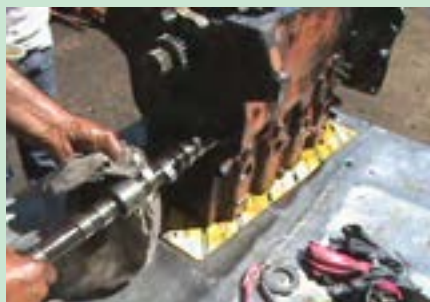
ب- خارج کردن میل سوپاپ
