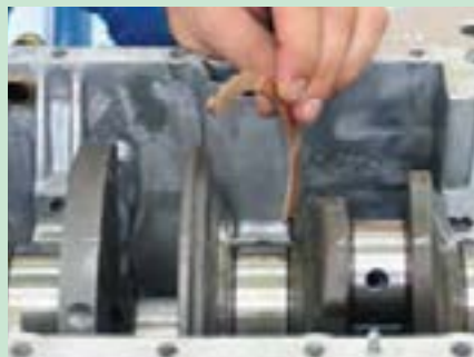
شکل ۵۰. برداشتن یاتاقان های ثابت و بغل یاتاقانی
