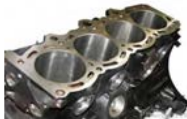
الف- سیلندر یکپارچه با بلوک سیلندر
