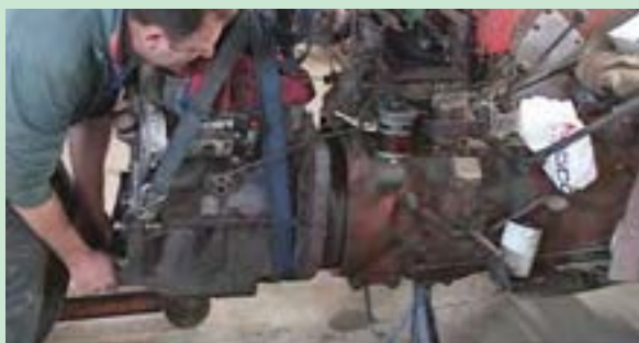
شکل ۳۲. جدا کردن موتور از جعبه دنده
