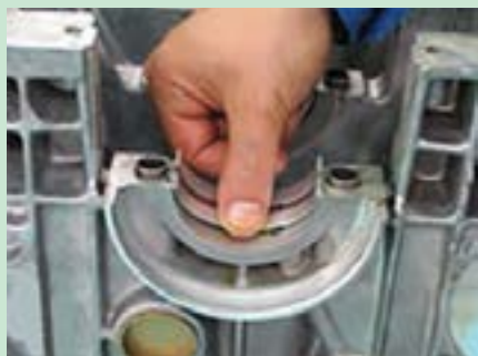
شکل ۵۰. برداشتن یاتاقان های ثابت و بغل یاتاقانی
