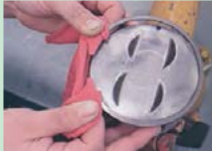
شکل ۵۳. خارج کردن رینگ بدون رینگ بازکن
