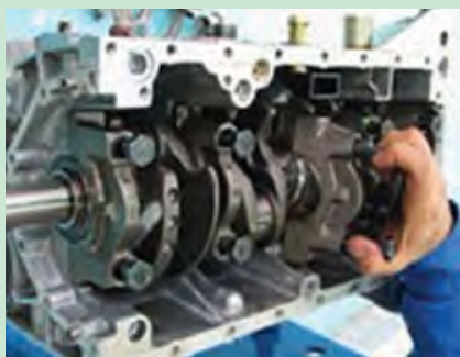
شکل ۴۸. برداشتن کپه‌های یاتاقان و چیدن آنها
