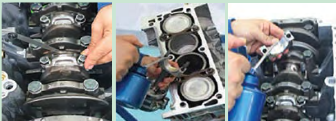
شکل ۱۰۱. روغن کاری کپه یاتاقان شاتون
