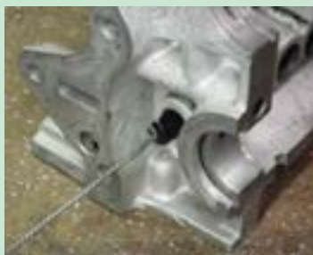
شکل ۵۹. تمیز کردن مجاری آب و روغن
