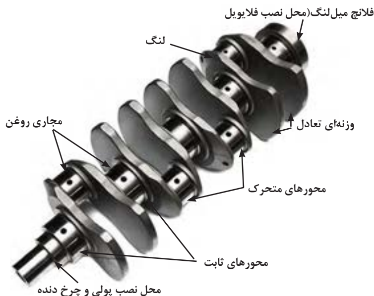
شکل ۱۶. اجزاء میل لنگ
