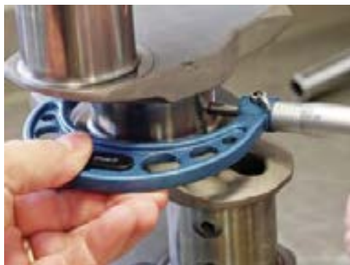
شکل ۷۱. اندازه گیری قطر میل لنگ
