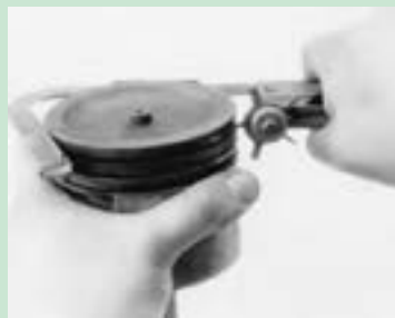
شکل ۵۸. روش های تمیز کردن شیار رینگ پیستون
