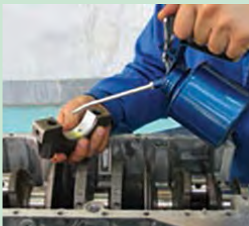
شکل ۹۵. روغنکاری یاتاقان ها قبل از نصب
