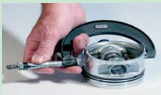
شکل ۷۵. اندازه‌گیری قطر پیستون با میکرو متر
