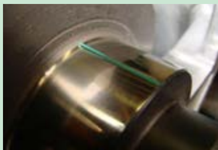
شکل ۸۶. قرار دادن پلاستی گیج روی محور میل لنگ
