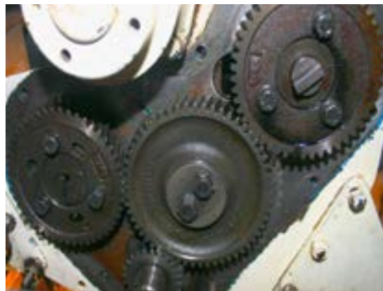
شکل ۲۷. چرخ دنده‌های تایمینگ در سینی جلو موتور
