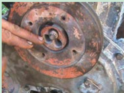
شکل ۱۱۳. پیچ های پولی سر میل لنگ
