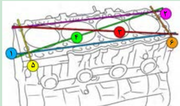
شکل ۶۸. تعیین میزان تاب برداشتن سطح بلوکه سیلندر با خط کش و فیلر
