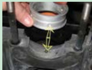
شکل ۹۳. قرار گرفتن سوراخ روغن مقابل هم
