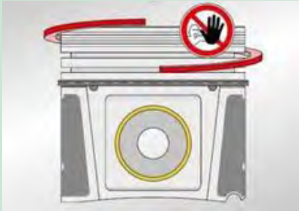
شکل ۵۳. خارج کردن رینگ بدون رینگ بازکن
