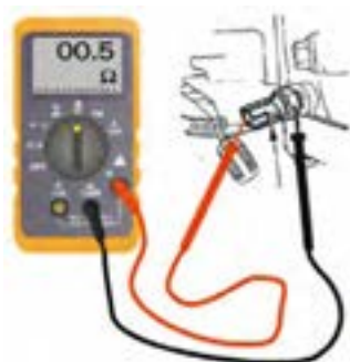
شکل ۴۹. کنترل فشنگی روغن
