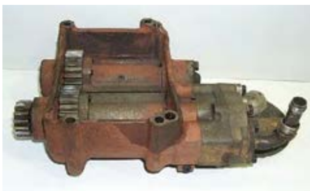
شکل ۴۴. بالانس‌های نصب شده روی پمپ روغن
