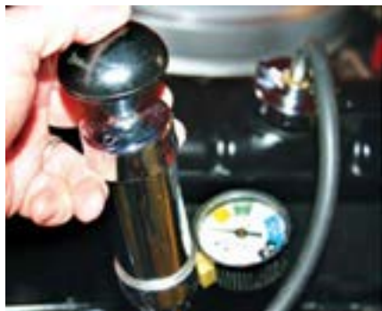
شکل ۶. آزمایش نشت یابی تحت فشار
