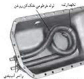
الف- عبور لوله مایع خنک‌کننده از کارتر ب- عبور مایع خنک‌کننده از پایه فیلتر JD314 ج- رادیاتور روغن U65° شکل ۴۶. انواع خنک‌کن روغن رایج در تراکتورها
