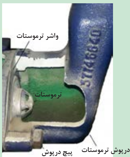
شکل ۱۷. نمای برش خورده ترموستات تراکتور MF285
