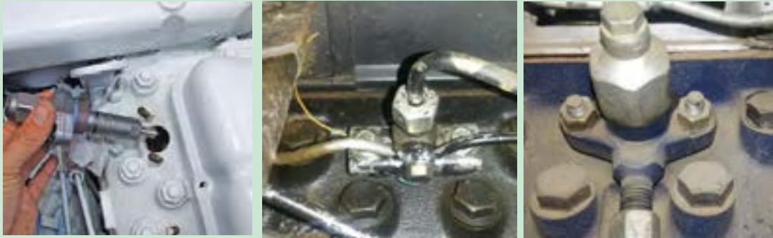
شکل ۳۴ الف. اتصالات انژکتور تراکتور MF285 شکل ۳۴ ب. اتصالات انژکتور تراکتور MF399 شکل ۳۵. خارج کردن انژکتور
