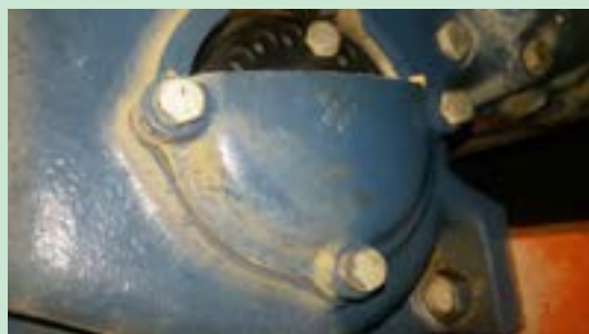
شکل ۳۳. تصویر برش خورده از درپوش زمان بندی و فلانچ پمپ انژکتور تراکتور U۶۵۰M
