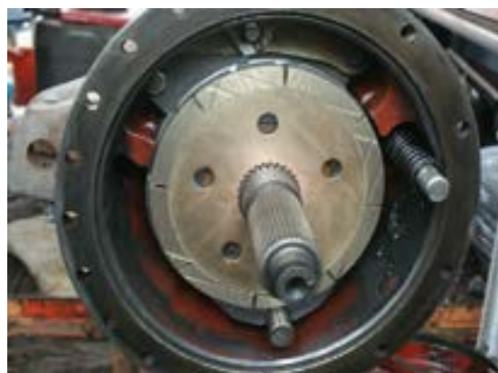
شکل ۳. پین های نگهدارنده مکانیسم ترمز
