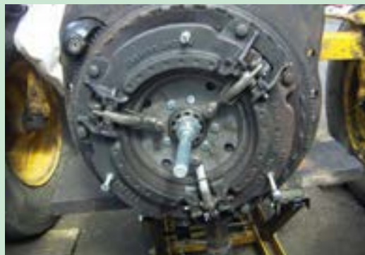
شکل ۳۷. سوار کردن مجموعه کلاچ روی فلاپیول
