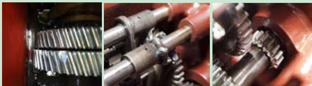
شکل ۴۰. برخی ایرادات قطعات جعبه دنده
