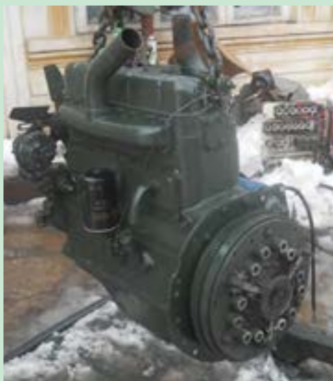
شکل ۲۴. پیاده کردن موتور تراکتور U650
