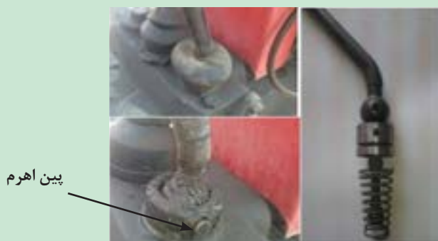
شکل ۲۹. خارج کردن اهرم‌های تعویض دنده
