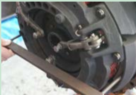
شکل ۳۸. تنظیم انگشتی‌های کلاچ
