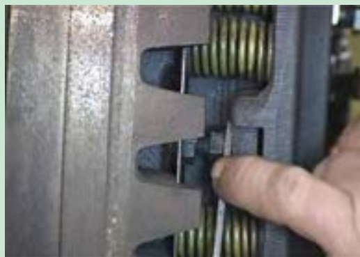
شکل ۳۹. تنظیم کلاچ محور تواندهی
