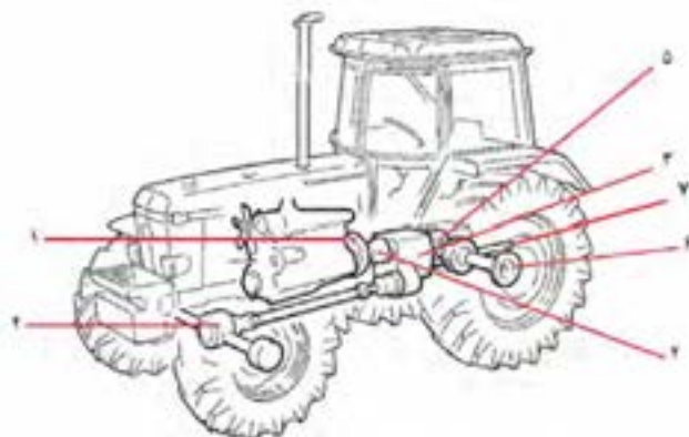
۱- کلاچ موتور، ۲- جعبه دنده کمک، ۳- جعبه دنده اصلی، ۴- دیفرانسیل جلو، ۵- دیفرانسیل، ۶- مجموعه کاهنده نهایی، ۷- محور تواندهی شکل ۱. اجزای سیستم انتقال قدرت
