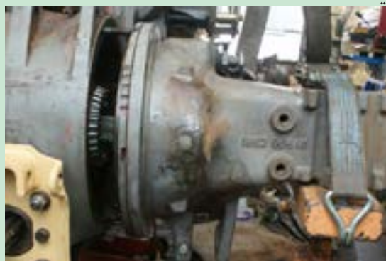
شکل ۷. باز کردن پوسته قیفی تراکتور MF۲۸۵
