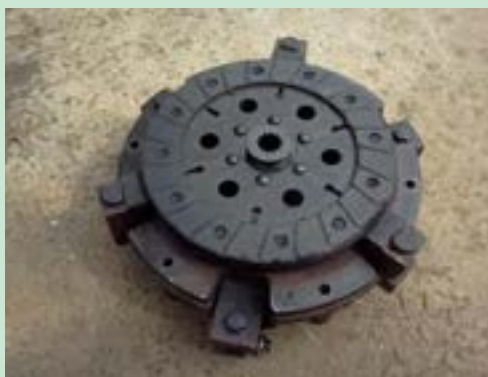
شکل ۲۵. جدا کردن مجموعه کلاچ از فلاپویل
