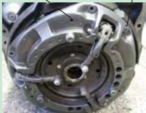
شکل ۲۵. جدا کردن مجموعه کلاچ از فلاپویل
