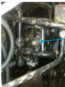
شکل ۱۰. پیچ هواگیری تراکتور MF۳۹۹
