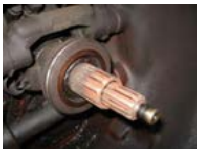
شکل ۱۹. موقعیت محور ورودی جعبه دنده و محور تواندهی
