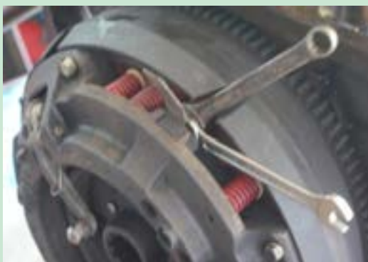
شکل ۳۹. تنظیم کلاچ محور تواندهی
