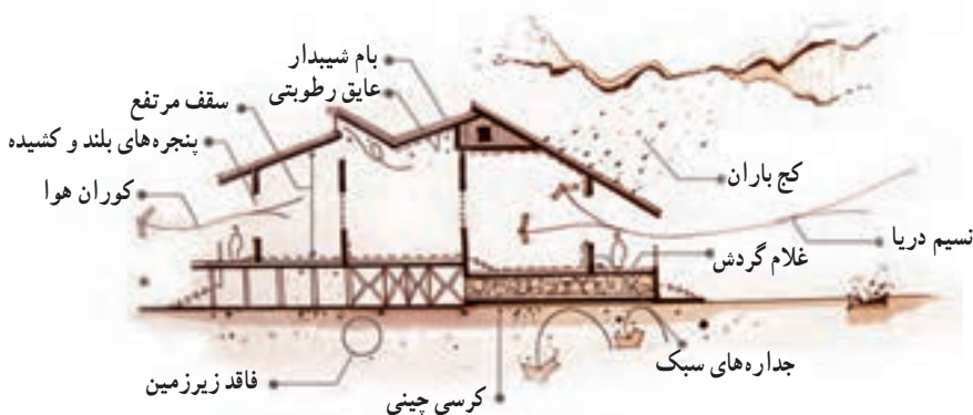
تصویر شماره ۱۰-۲- نمودار ویژگی های اقلیمی خانه در اقلیم معتدل و مرطوب
