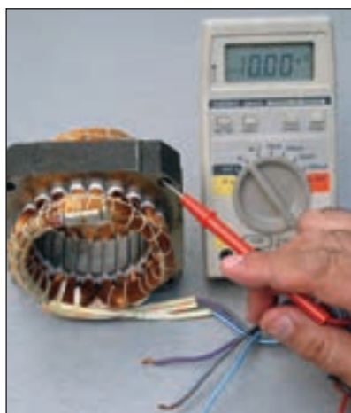
▲ شکل ۱۴-۲- تست اتصال بدنه
