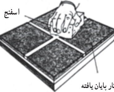
شکل ۲-۸- نحوه بندکشی کاشی شامل مراحل پهن کردن دوغاب و تمیز کردن سطح کاشیها
