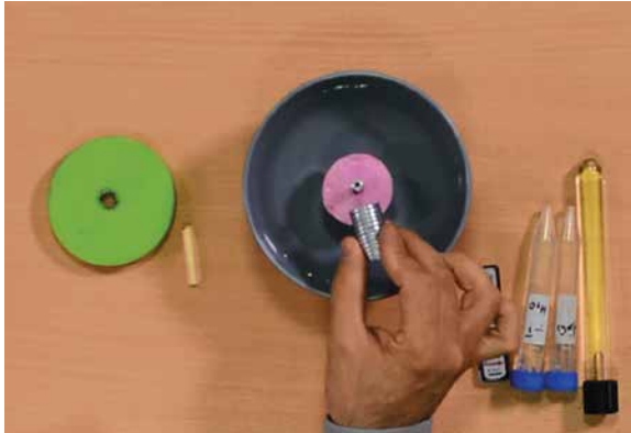
آلومینیم به عنوان یک ماده پارامغناطیس، به آرامی به طرف آهنربای قوی حرکت می‌کند.
