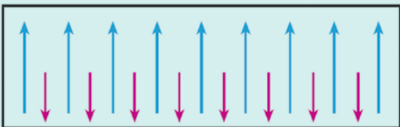
یک حوزه مغناطیسی مربوط به ماده فری مغناطیس، در مواد فری مغناطیس برآیند گشتاورهای مغناطیسی در هر شبکه مخالف صفر است.
