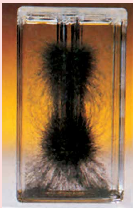
میدان مغناطیسی آهنربای میله ای در سه بعد
