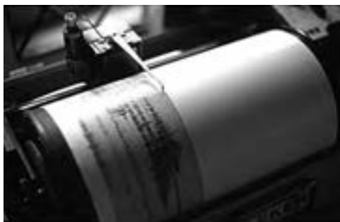
لرزه نگار دستگاهی است که نوسانات زمینی ناشی از ورود امواج لرزه ای را همراه با علائم بسیار دقیق زمانی ثبت می کند.
