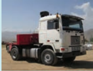
شکل ۲۰- محور راهنما (مطابق ردیف ۱ جدول بار محوری مجاز): ۸ تن محور منفرد (مطابق ردیف ۲ جدول بار محوری مجاز): ۱۳ تن محور تریوله (مطابق ردیف ۴ جدول بار محوری مجاز): ۲۴ تن
