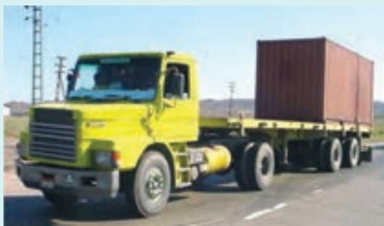
شکل ۳۰- عدم استقرار مناسب بار روی بارگیر
