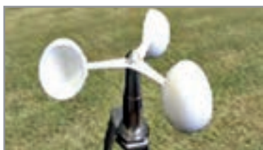
نوع فنجان‌ی با محور عمودی بر جهت جریان آب (cup type) نوع پره‌ای با محور افقی (Propeller type)
