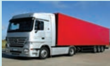
شکل ۲۱- نوع وسیله نقلیه و تعداد چرخ: تریلی پنج محور (دوازده چرخ) وزن کل مجاز ۴۲ تن
