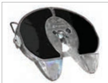
شکل ۱۲- نمونه‌هایی از تصاویر مربوط به صفحه‌ریش و اتصال (تریلی)
