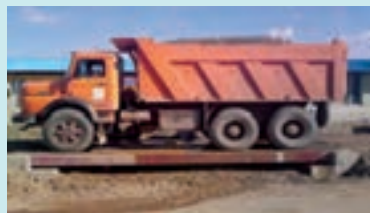
شکل ۲۳- نوع وسیله نقلیه و تعداد چرخ: کامیون سه محور (ده چرخ) وزن کل مجاز: ۲۸ تن
