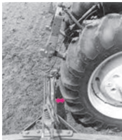
شکل ۳۵-۱- زاویه تند بین مالبندها تراکتور و پی‌نورد
