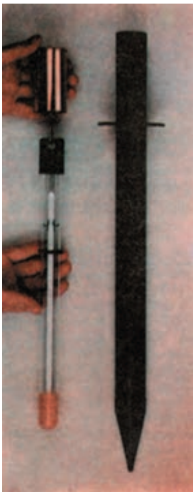
شکل ۲-۲- دماسنج برای اندازه‌گیری درجه حرارت خاک
