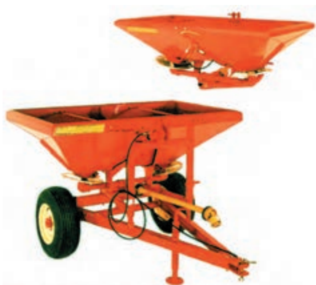
شکل ۲-۲- بذریاش سانتریفوژ با چرخهای ثابت (کششی)
